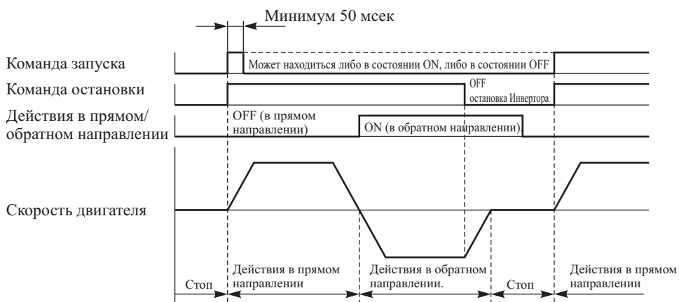
Рисунок 6.14 Временная диаграмма для управления по трехпроводной линии.
