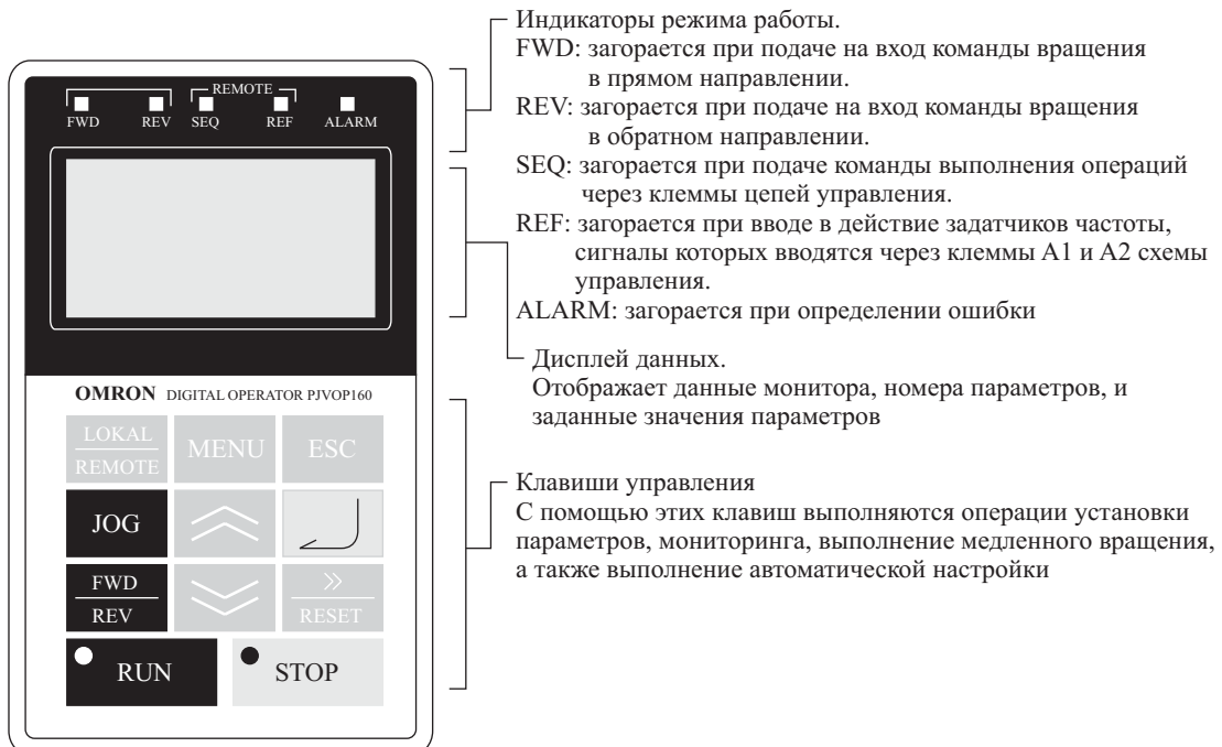
Рисунок 3.1 Наименование компонентов Цифрового пульта управления и его функции.
