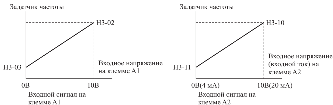
Рисунок 6-27 Входные сигналы на клеммах A1 и A2.
