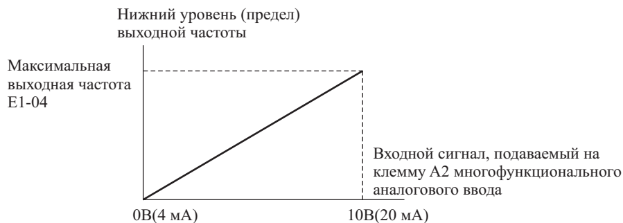
Рисунок 6.33 Зависимость нижнего уровня выходной частоты от сигнала аналогового ввода.
