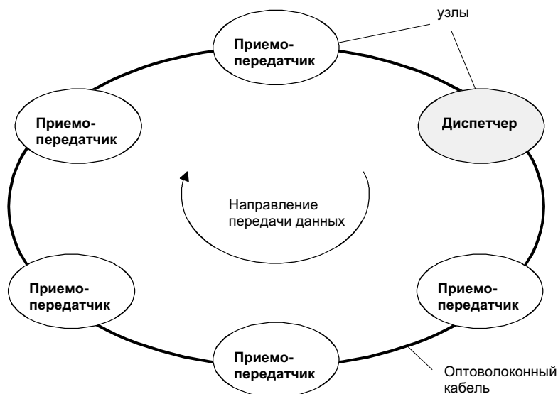
Рис. 8.3-3 SIMOLINK с диспетчером
