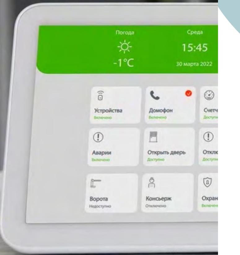
IP – домофония с контролем доступа. Возможность вывода изображений с камер видеонаблюдения жилого комплекса на установленный в квартире планшет или смартфон
