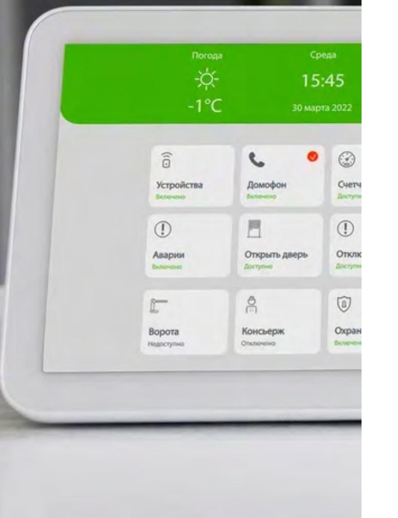
IP – домофония с контролем доступа. Возможность вывода изображений с камер видеонаблюдения жилого комплекса на установленный в квартире планшет или смартфон
