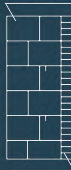
кирпичная кладка из облицовочного кирпича — 120 мм
