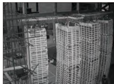
мониторинг деформации вибрационные испытания больших зданий
