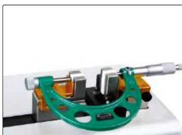
установка нуля и калибровка микрометров
