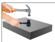
удар молотком для приложения испытательного усилия
