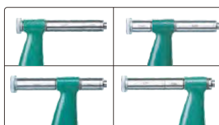
регулировка манжет для различных диапазонов измерения
