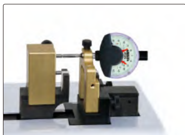
калибровка циферблатного компаратора
