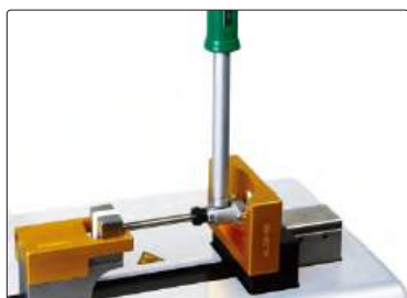
установка нуля и калибровка расточных манометров
