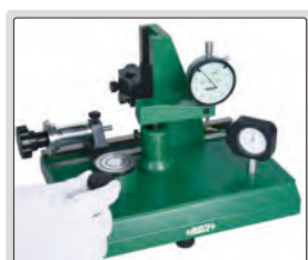
проверка усилия циферблатных индикаторов
