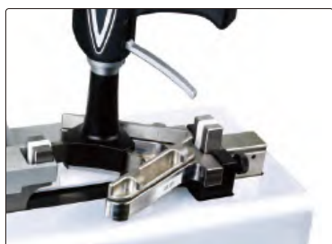
установка нуля и калибровка трехточечных внутренних микрометров
