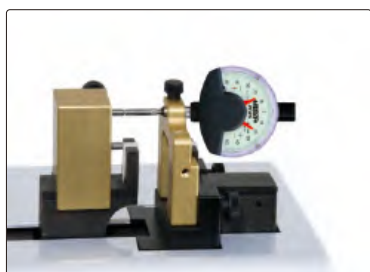
калибровка циферблатного компаратора
