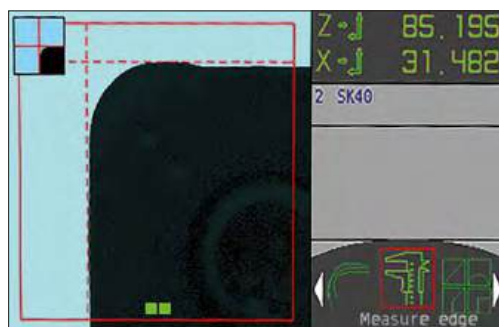
автоматическое распознавание формы режущей кромки
