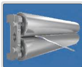
измерение зазора между валками
