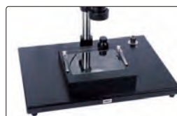
стеклянный столик X-Y (опция) (X-Y ход: 100×86 мм)
