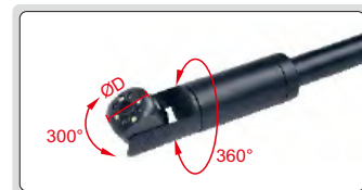
двойное моторизованное управление обзором объектива, 300° по горизонтали и 360° по вертикали
