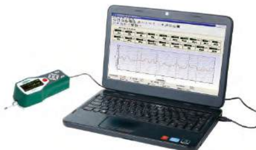
управление тестером шероховатости с помощью компьютера
