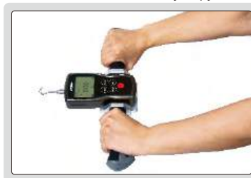
тест на вытягивание с двумя руками
