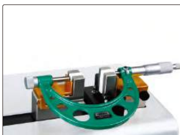
установка нуля и калибровка микрометров
