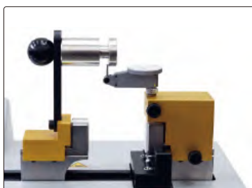
установка нуля и калибровка циферблатного компаратора
