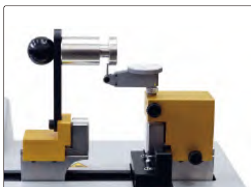
установка нуля и калибровка циферблатного компаратора
