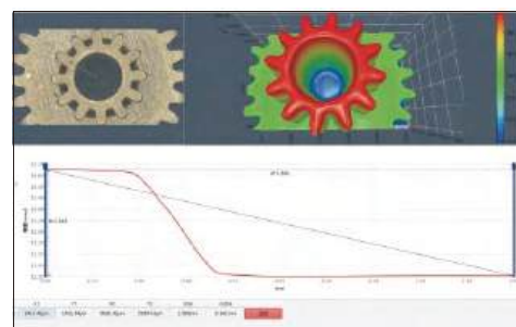
измерение высоты отверстия компонента
