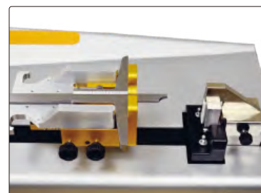
калибровка глубинного штангенциркуля
