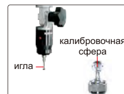
калибровочная сфера игла датчик (опция), включает в себя иглы Ø2 мм и Ø3 мм, калибровочную сферу Ø25 мм, точность измерения 10 мкм
