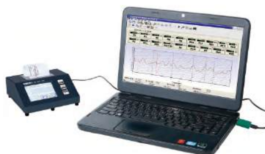
управление тестером шероховатости с помощью компьютера
