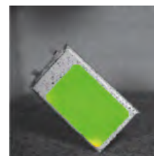
испытание батарейного блока на падение изображение поля деформации
