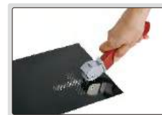
шаг 1: создание сетки надрезов на поверхности
