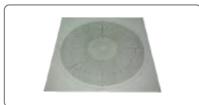
прозрачная палетка (угломер с ценой деления 1°, радиус с шагом 1 мм)
