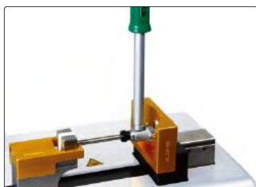
установка нуля и калибровка расточных манометров
