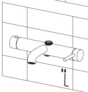
2. Равномерно нанесите силиконовую смазку на уплотнительные кольца соединения, наденьте смеситель на эксцентрики, прижмите к стене и зафиксируйте четырьмя винтами.
