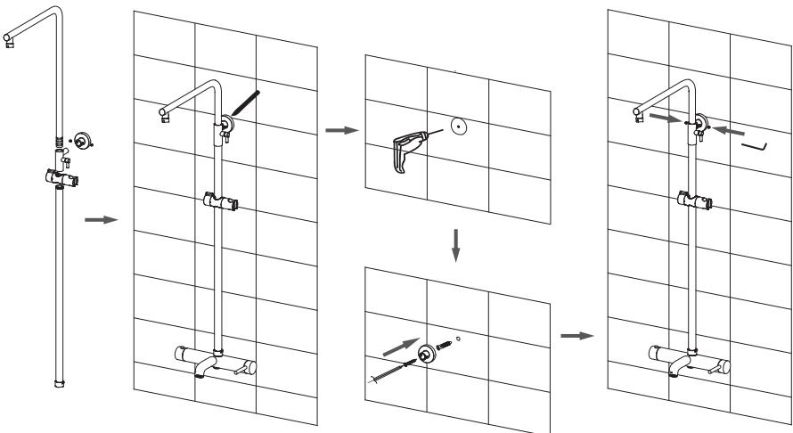
3. Соедините вертикальную трубу со смесителем и произведите разметку верхнего крепления трубы на стене. Прикройте смеситель во избежание повреждений. Просверлите отверстие в стене (D 8 мм, L 40 мм), используя подходящий тип сверла для данного типа облицовки. Установите крепление на стене и зафиксируйте на нем вертикальную трубу.
