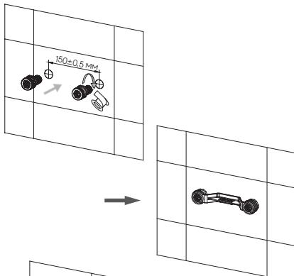
1. Установите в водорозетки эксцентрики, используя материал для герметизации водопроводных резьбовых соединений.
