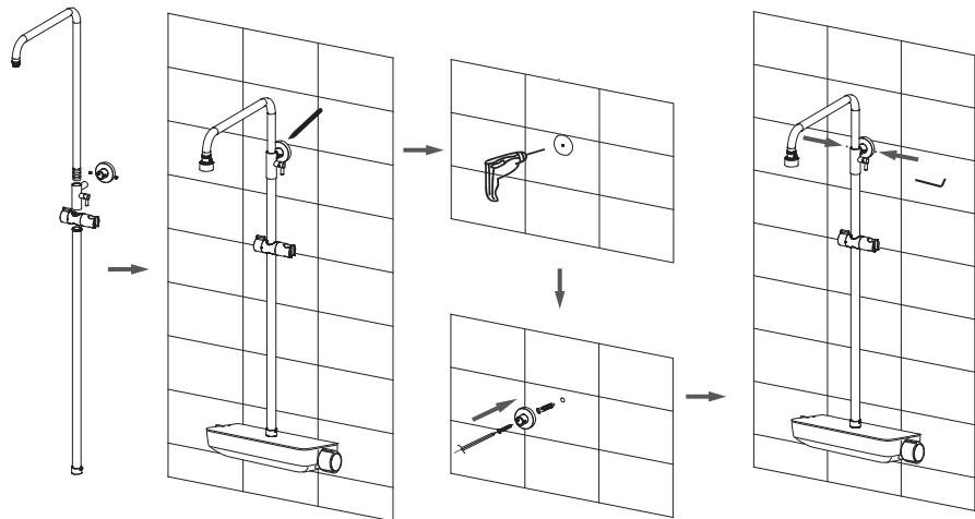
3. Соедините вертикальную трубу со смесителем и произведите разметку верхнего крепления трубы на стене. Прикройте смеситель во избежание повреждений. Просверлите отверстие в стене (D 8 мм, L 40 мм) используя подходящий тип сверла для данного типа облицовки. Установите крепление на стене и зафиксируйте на нем вертикальную трубу.
