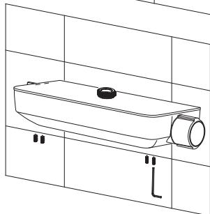
2. Равномерно нанесите силиконовую смазку на уплотнительные кольца соединения, наденьте смеситель на эксцентрики, прижмите к стене и зафиксируйте четырьмя винтами.
