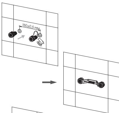
1. Установите в водорозетки эксцентрики, используя материал для герметизации водопроводных резьбовых соединений. Используйте входящий в комплект монтажный уровень.
