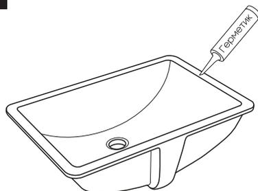
2. Нанесите сантехнический герметик, подходящий по составу к материалу столешницы, на борт раковины.
