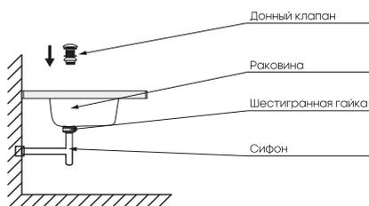
4. Установите донный клапан в сливное отверстие и зафиксируйте его с помощью шестигранной гайки. Подсоедините сифон. Донный клапан и сифон не входят в комплект поставки раковины.
