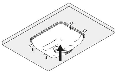
3. Прижмите раковину к столешнице снизу и зафиксируйте раковину с помощью креплений (не входят в комплект раковины).
