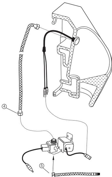
2. Установка шлангов и блока питания. Подсоедините один конец длинного шланга (5) к форсунке, а другой конец – к выпускному отверстию электромагнитного клапана блока управления.
