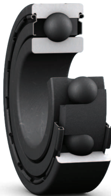
Высокотемпературные подшипники SKF 6205-2Z/VA292 предлагают решение без содержания PWIS для процессов сушки на окрасочных линиях.
