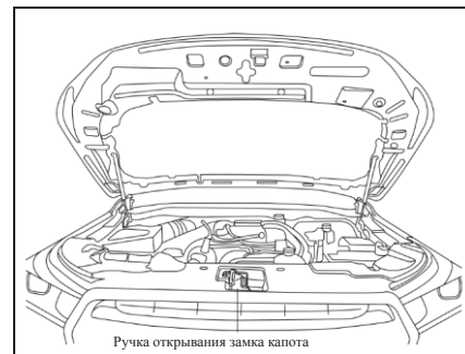
Ручка открывания замка капота
