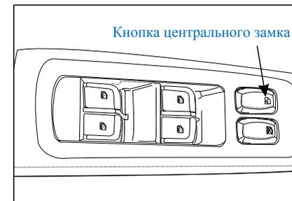
Кнопка центрального запираения встроена в основную панель управления выключателя стеклоподъемника левой передней двери. Управляйте кнопкой изнутри, чтобы заблокировать или разблокировать все двери. Нажмите переднюю часть кнопки, и все двери будут заблокированы. Нажмите задний конец кнопки, и все двери будут разблокированы.
