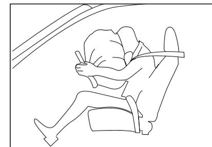
Подушка безопасности мгновенно сдувается после взрыва, чтобы не закрывать обзор и позволить водителю управлять рулевым колесом или другими устройствами.
