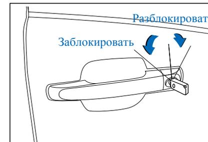
Чтобы заблокировать двери ключом снаружи, вставьте ключ и поверните его против часовой стрелки. Чтобы разблокировать их, поверните ключ по часовой стрелке и потяните ручку на себя, чтобы открыть дверь.
