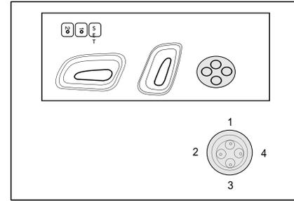
Ваше кресло имеет поясничную опору. Нажмите кнопку 1, и верхняя часть поясничной опоры поднимется. Нажмите кнопку 2, и верхняя и нижняя части поясничной опоры повысятся. Нажмите кнопку 3, и нижняя часть поясничной опоры поднимется. Нажмите кнопку 4, и поясничная опора сдвнется. Нажмите кнопку и удерживайте ее до тех пор, пока подушка безопасности не раздуется до желаемого положения.
