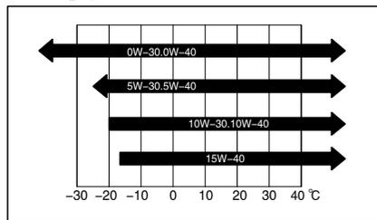
Всегда используйте тип топливного моторного масла с маркировкой «Качество, отвечающее критериям классификации API и выше SJ». Формула масла помогает снизить расход топлива двигателя.
