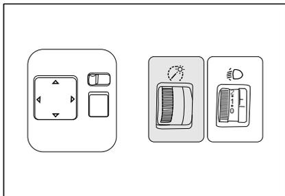
Ручка регулировки яркости расположена на переключателе рядом с левой стороной приборной панели. Поверните ручку настройки яркости, чтобы настроить яркость различных габаритных огней на приборной панели. Только при включении габаритных огней может работать ручка настройки.
