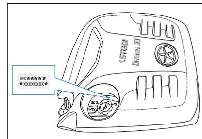
Серийный номер двигателя печатается на цилиндре двигателя, который находится рядом с индикатором уровня масла.
