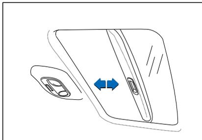
Вы можете повернуть заслонку люка крыши вперед или назад, когда люк закрыт. При открытии люка люк в крыше открывается автоматически, но его необходимо закрыть вручную.
