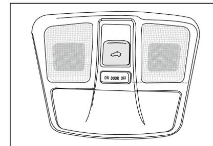
Поверните ключ зажигания в положение «ON», чтобы люк открывался или закрывался. Кнопка переключения люка на крыше расположена на передней панели потолочного освещения. Потяните конец кнопки " " чтобы контролировать падение и закрытие люка крыши; Надавите на конец кнопки " " чтобы контролировать подъем и вскрытие люка.
