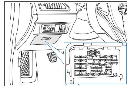
Этот блок предохранителей расположен в боковой панели в нижнем левом углу инструмента.
