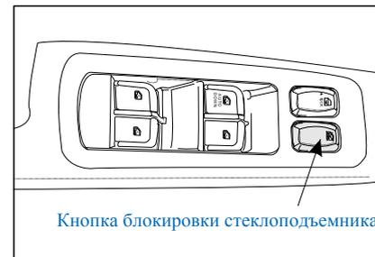
Для того, чтобы пассажиры не могли управлять окном и задними окнами, на главной панели управления также имеется кнопка блокировки стеклоподъемников.
