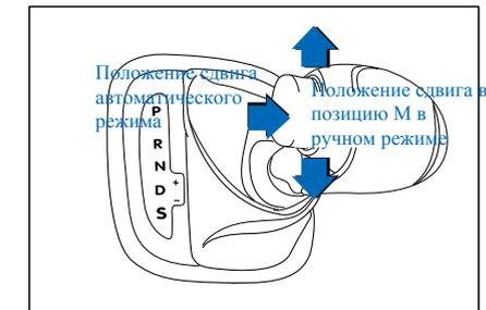
Переместите рычаг переключения передач в поперечном направлении из положения D в положение M, где вы можете в скором времени перемещаться вверх или вниз по рычагу переключения передач.
