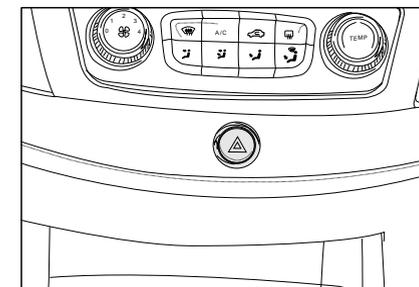
Переключатель аварийных огней расположен на центральной приборной панели, на которой имеется треугольная метка, как показано на рисунке выше.
