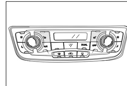
У сиденья водителя и переднего пассажира есть функция обогрева. Нажмите кнопку на панели кондиционера, и подушка сиденья и спинка будут нагреваться. Нажмите кнопку еще раз, и нагрев будет остановлен при выключенном индикаторе кнопки.
