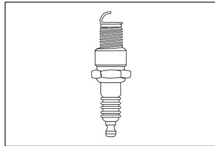
Свеча зажигания должна быть заменена в соответствии с рекомендуемым периодом в руководстве по обслуживанию и сервису JAC. И если двигатель не запускается, расход топлива является чрезмерным или производительность ускорения становится плохой, пожалуйста, демонтируйте свечу зажигания, чтобы проверить и отрегулировать зазор, или заменить его, если это необходимо. При замене свечи зажигания обратите внимание на следующие предметы:
