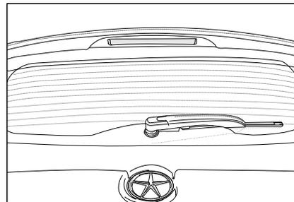
Высокий тормозной свет используется для усиления напоминания и предупреждающего эффекта тормозных огней.
