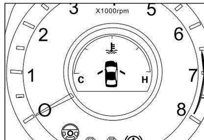
Водяной термометр отображает температуру охлаждающей жидкости двигателя при включенном зажигании. При температуре более 60 ° C, показания термометра будут в 1 зоне. При нормальной работе автомобиля, полоса индикатора воды будет находиться в средней зоне. Когда полоса индикатора воды достигает седьмой зоны, загорается контрольная лампа, что указывает на то, что температура охлаждающей жидкости двигателя превысила нормальное значение.
