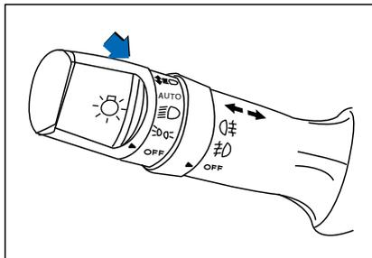
Когда ключ зажигания в положении LOCK, поднимите рычаг управления сигналом поворота (рычаг переключения луча) в направлении рулевого колеса, а затем опустите его. Функция сопровождения активируется, а затем фары будут иметь постоянное освещение в течение 30 секунд.
