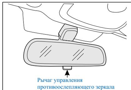
Перед вождением внутренние и наружные зеркала заднего вида должны быть отрегулированы до оптимального угла обзора, сохраняя чистое зеркало заднего вида. Выберите удобное положение вождения и отрегулируйте зеркало заднего вида, чтобы увидеть заднюю часть автомобиля. Возьмитесь за середину, чтобы двигаться вверх и вниз или
