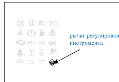
Вы можете выбрать любую строку из трех, вращая регулировочный рычаг по или против часовой стрелки. Выбранная строка будет отражена миганием лампы. Затем нажмите рычаг регулировки инструмента в течение 0,3-2с, чтобы отобразить содержимое.
