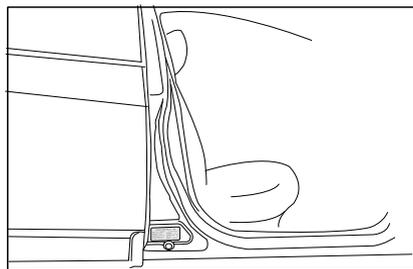
Паспортная табличка - это стойка кузова автомобиля, расположенная в нижней части передней правой двери. На паспортной табличке указаны ИНТС, номер двигателя, максимальная чистая мощность, номер шасси, перемещение, максимальная разрешенная общая масса, дата производства и т. Д.
