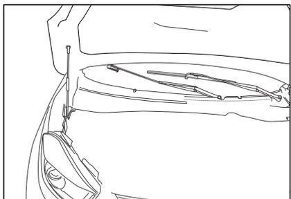
> Вытащите опорный стержень из зажима и поместите его в отверстие капота, чтобы поддерживать капот двигателя.
