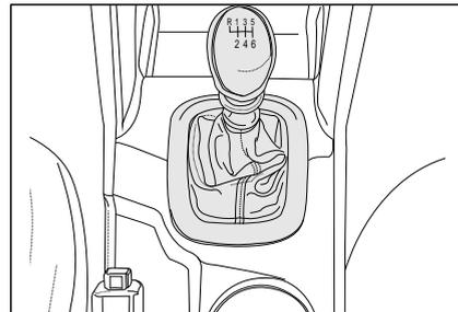
Каждое положение шестерни обозначено на ручке ручной коробки передач. Все шестерни в коробке передач снабжены синхронизаторами, что делает все виды операций переключения очень легкими. При переключении на передачу заднего хода потяните и удерживайте фиксатор заднего хода под рычагом переключения передач, а затем переключите рычаг переключения передач в положение заднего хода.
