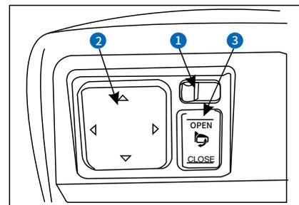
Кнопка регулировки внешних зеркал расположена на переключателе соединения в левом нижнем углу панели приборов со стороны водителя.
