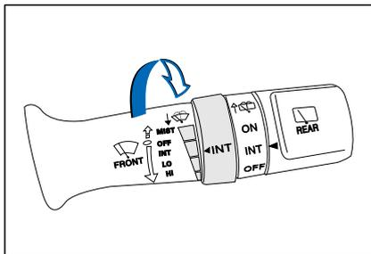
Поверните рычаг стеклоочистителя и омывателя в положение "INT" чтобы сделать работу стеклоочистителя прерывистой. Когда рычаг находится в прерывистом рабочем положении, прокрутите центральную рукоятку рычага, чтобы отрегулировать скорость движения. Когда вы поворачиваете рычаг стеклоочистителя и омывателя на низкую скорость «LO», высокоскоростное положение «HI», стеклоочиститель будет непрерывно протирать с разной скоростью.
