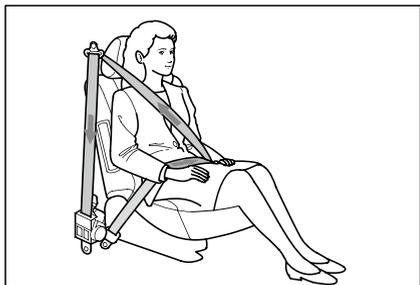
Ваш автомобиль оснащен предварительными натяжителями ремней безопасности, которые предназначены для водителя и пассажира на правом переднем сиденье. Целью установки преднатяжителей является защита водителя и пассажира, при лобовом столкновении.
