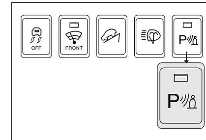
Система помощи при парковке помогает обеспечить водителя предупреждением о препятствиях, когда транспортное средство движется с низкой скоростью. Если система обнаруживает определенный объем объекта на расстоянии 100 см впереди и 150 см от задней части автомобиля, система отправит предупреждающий звук. Система является вспомогательной системой, которая не может предсказать или автоматически избежать препятствий. Поэтому вы не можете расслаблять бдительность, даже если система оборудована.
