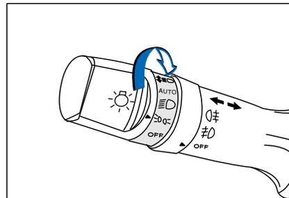
Ручка переключателя на конце рычага света и рычага переключения света может управлять дальностью света. Поверните переключатель в положение "D" и включите габаритные огни, свет номерного знака, подсветку инструментов и панели. Переведите переключатель в положение "D" и вы включите ближний свет.
