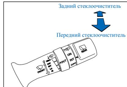
Чтобы использовать передний омыватель стекла, потяните за рычаг на себя. Таким образом, омыватель будет распылять воду, и стеклоочиститель будет двигаться на низкой скорости, они не остановятся, пока рычаг не отпустят. Когда вы отпустите рычаг, стеклоочиститель будет протирать несколько раз, а затем остановится.
