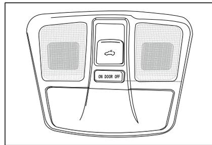
Свет из передних потолочных светильников делает его удобным для ночного чтения или может использоваться как частное освещение для водителя или пилота. Переключатель переднего потолочного освещения имеет три положения: левое, среднее и правое (как показано на рисунке: левое положение включено, среднее положение - управление дверью, правое положение выключено). В положении ON передняя потолочная лампа будет
