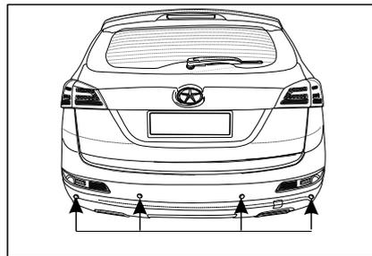
Реверсивная радиолокационная система использует радиолокационные датчики для определения наличия препятствий позади транспортного средства и отправки сигналов тревоги, когда транспортное средство движется назад со скоростью менее 5 км/ч или парками. Это только вспомогательная система.
