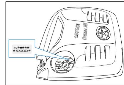
Серийный номер двигателя 1,5 TGDl наклеивается на масляный фильтр.
