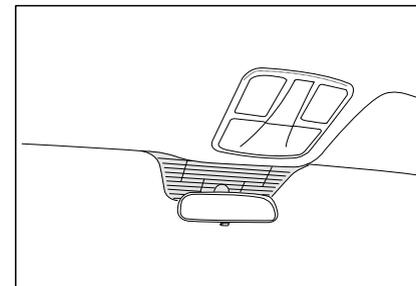
Для моделей, оснащенных компакт-диск, аудиосистема AM-FM-антенна расположена на переднем стекле ветровой зоны. Удостоверьтесь, что линии сетки на ветровом стекле не повреждены. В противном случае это будет мешать приему радиосигналов.
