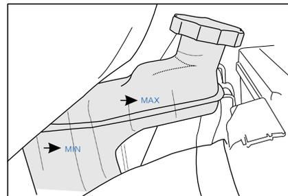
Периодически проверяйте тормозную жидкость в резервуаре, и уровень должен быть между «MAX» и «MIN». Во время езды уровень жидкости падает из-за износа и автоматической регулировки тормозной фрикционной пластины, и это нормально. Но если уровень упал значительно или даже ниже «MIN», уплотнение тормозной системы может иметь некоторые проблемы. Если уровень слишком низкий, загораются сигнальные лампы ручного тормоза и тормозной системы, поэтому
