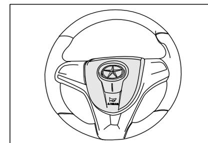
Нажмите на символ рупора на рулевом колесе, прозвучит сигнал. Регулярно проверяйте условия работы клаксона, чтобы убедиться, что клаксон может работать правильно.
