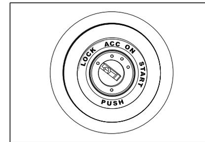
Выключатель зажигания расположен с правой стороны рулевой колонки под рулем. Существует четыре положения переключателя:
