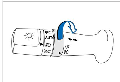
Передний и задний противотуманные фары включаются на переключателе поворота и рычаге переключения света. Когда ручка управления находится на конце рычага в положении "☀" или "☀" вращайте ручку до позиции "☀" чтобы включить передние противотуманные фары. В то же время на панели инструментов загорится индикатор "☀" Когда включены передние противотуманные фары, переведите рычаг в позицию "☀" и опустите рычаг для включения задних противотуманных фар.
