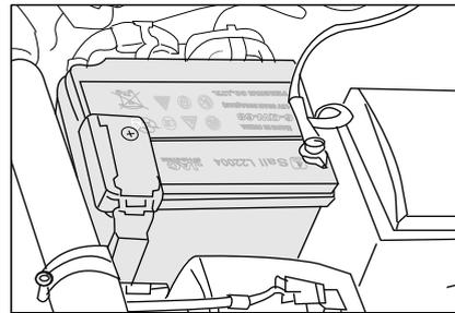
Ваше транспортное средство оснащено необслуживаемой батареей. Если вам нужно заменить батарею, просто выберите батарею с таким же номером детали с оригинальным. Пожалуйста, обратитесь в филиал «Engine Room», чтобы подтвердить местоположение батареи.
