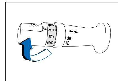
Когда ручка барреля в конце поворотного света и рычаг изменения света повернется в положение AUTO, начнется автоматическая система управления освещением. В соответствии с яркостью света, он автоматически контролирует включение / выключение ближнего света фар, габаритные огни и фоновые огни. Когда снаружи темнеет, например, когда автомобиль движется в сумерках, ночью или в туннеле и т. Он автоматически включит ближний свет фар, габаритные огни и фоновые
