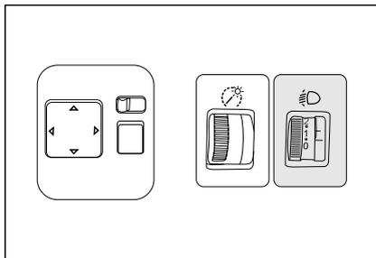
Регулятор высоты фар расположен на комбинированном переключателе под левой стороной приборной панели с пятью уровнями. Когда фары включены, прокрутите ручку, чтобы отрегулировать нижний луч фары на нужную высоту. Только когда фары включены, может работать ручка регулировки высоты фар.
