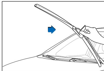
> Включите выключатель зажигания и выключите его снова. Поднимите плечо стеклоочистителя, чтобы снять его с переднего лобового стекла, затем откройте крышку адаптера стеклоочистителя;
