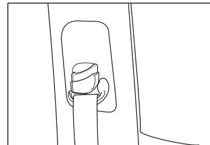
Высота ремня безопасности в переднем ряду регулируется через фиксированную кассету. Регулировка ремня безопасности должна выполняться поверх живота и груди, через плечо, а не шею. Если ремень безопасности расположен близко к шее, вы не получите самую эффективную защиту.
