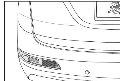
Задний противотуманный фонарь используется для уведомления водителей сзади и пешеходов о вашем автомобиле в плохой видимости, чтобы избежать излишнего хаоса трафика.
