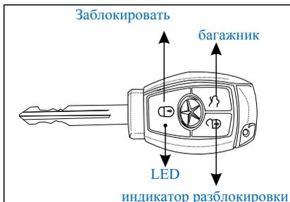
Удаленная система блокировки может использоваться для блокировки и разблокировки всех дверей.
