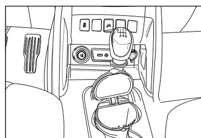
Ваше транспортное средство оснащено дополнительной розеткой. Используя розетку электропитания, вы можете вставить дополнительное электрооборудование. Когда переключатель зажигания находится в положении «АСС» или «ВКЛ», дополнительная розетка питания может подавать питание. Чтобы использовать розетку, потяните крышку.
