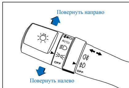
Используйте рычаг указателя поворота (рычаг переключения света), чтобы уведомить о повороте и изменении полосы движения другим автомобилям и пешеходам.
