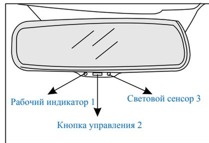
Автоматическая функция защиты от ослепления может включаться и выключаться кнопкой управления 2.
