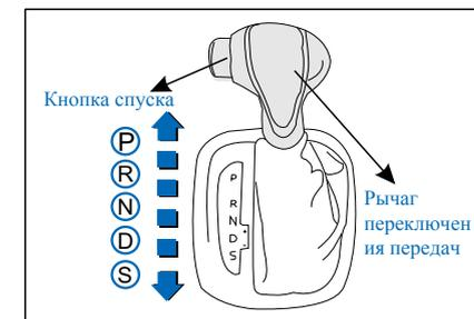
Рычаг переключения передач имеет механизм блокировки переключения. Когда рычаг переключения передач перемещается из положения P в рабочее положение, вы должны нажать педаль тормоза и нажать кнопку разблокировки на рукоятке. Перемещение рычага переключения передач должно соответствовать
