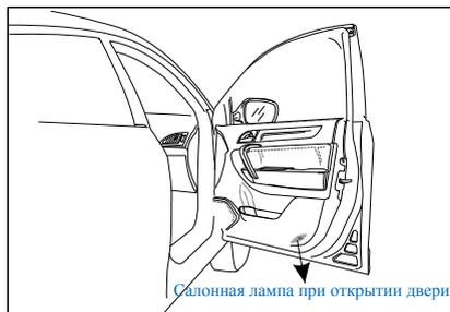
Свет управления дверью расположен на внутренней стороне передних дверей. Когда вы откроете дверь, загорится контрольная лампочка управления. После того, как вы закроете любую из входных дверей, загорится соответствующий индикатор управления дверью.
