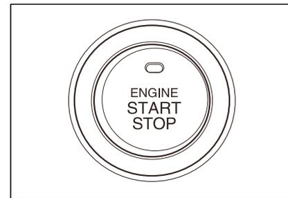
**Ключевой пусковой переключатель:** ключевой пусковой переключатель представляет собой инструмент взаимодействия человека и компьютера системы PEPS. Путем нажатия на него пользователь отправляет переключатель питания, запрос запуска двигателя и завершения работы в систему PEPS.
