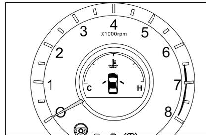
Тахометр показывает число оборотов двигателя в минуту (об / мин). Чтобы предотвратить повреждение двигателя, не водите автомобиль, когда указатель указывает на красную зону. Начало секции красной зоны на циферблате определяется соответствующей моделью двигателя.
