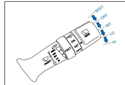
Этот рычаг используется для управления стеклоочистителем и омывателем. Когда ключ зажигания находится в положении ВКЛ, стеклоочиститель и омыватель готовы к работе. Стеклоочистители имеют пять положений:
