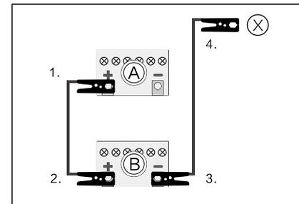
**Кабель перемычки должен быть подключен в следующей последовательности:**
