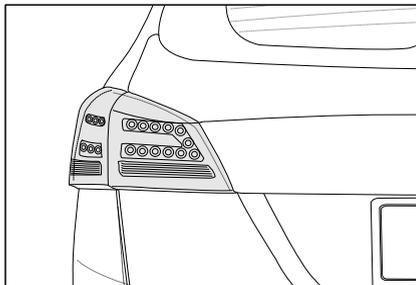
Тормозной свет используется, чтобы уведомить и пропустить задних водителей и пешеходов, заметив состояние передних дорог.
