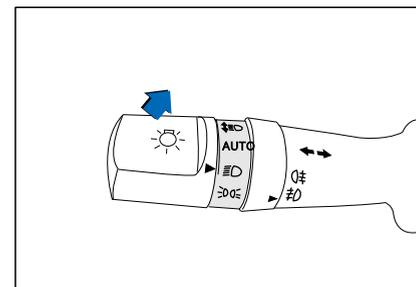
Поверните ручку переключателя в положение "D" и нажмите на него до щелчка, который означает включение дальнего света. Индикатор дальнего света загорится на приборной доске, когда включатся фары. Чтобы переключиться на ближний свет, просто потяните рычаг переключателя назад.
