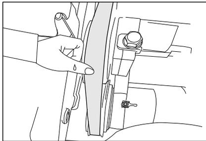
> Проверьте состояние ремня привода, чтобы увидеть, есть ли трещина или износ на каждом крае ремня. Если вы обнаружите какую-либо трещину или износ, свяжитесь с сервис службой JAC, чтобы заменить его.
