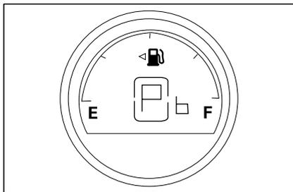
Топливный датчик отображает текущий объем топлива в топливном баке. Индикатор топлива будет включен вместе с зажиганием. Когда горит контрольная лампа, это указывает на низкий уровень топлива, что уменьшит степень охлаждения топливного насоса, поэтому необходимо заправиться, чтобы гарантировать нормальную работу автомобиля.
