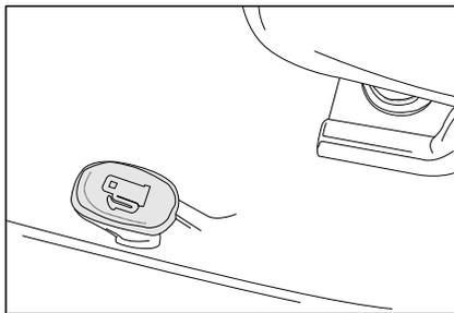
Кнопка разблокировки крышки топливного бака расположена на полу под сиденьем водителя. Потяните вверх кнопку, чтобы открыть крышку топливного бака.
