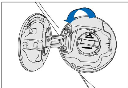
Топливный бак устанавливается в левой задней боковой части кузова автомобиля. Вот шаги для способа дозаправки:
