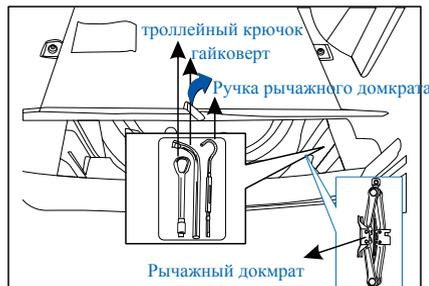
Запасная шина и коробка инструментов для водителя Refine S5 находятся в отсеке запасных шин под ковриком в багажном отделении. Вы можете получить эти инструменты, открыв багажник и подняв коврик.
