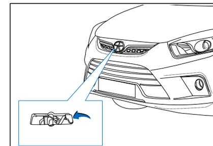
> Положите руку на внутреннюю сторону переднего края капота, переключите предохранительный рычаг и поднимите капот.
