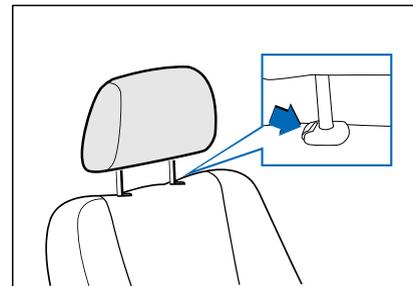
Чтобы снять подголовник, подтяните подголовник до самого высокого уровня и нажмите кнопку фиксатора, чтобы снять его со спинки. Чтобы установить подголовник, вставьте подголовник в направляющую трубу в спинку, пока не появится сетчатый звук от кнопки разблокировки.
