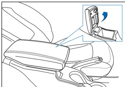
Центральная консоль имеет ящик для хранения, крышка которого также подлокотник. Чтобы открыть ящик для хранения, поднимите открытую ручку и потяните крышку подлокотника. Чтобы закрыть ящик для хранения, нажмите крышку, пока она не закроется.
