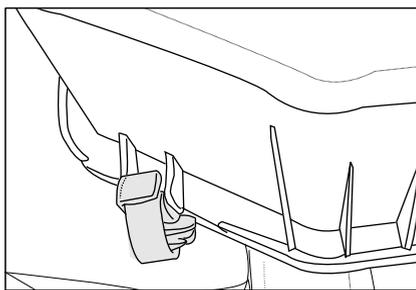
> Ослабьте четыре фиксатора воздушного фильтра и откройте его.
