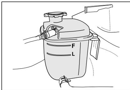
Проверьте уровень охлаждающей жидкости, когда температура двигателя и температура окружающей среды совпадают.
