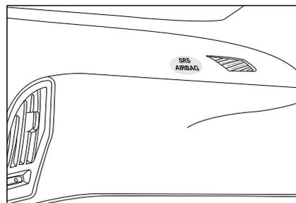
Система фронтальной подушки безопасности содержит две подушки безопасности, одна находится на рулевом колесе, а другая - в приборной
