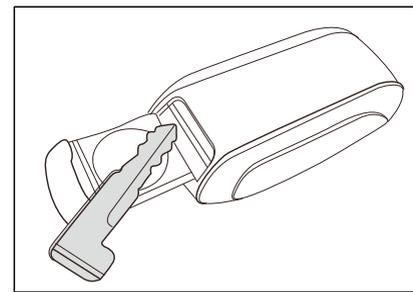
Механический ключ встроен в смарт-ключ. Если смарт-ключ не работает, воспользуйтесь механическим.
