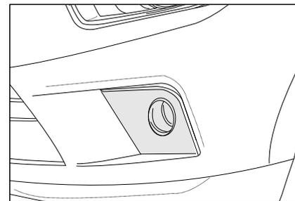
В условиях низкой видимости дневные ходовые огни могут быть легче идентифицированы другими транспортными средствами. Передний противотуманный свет используется для обеспечения определенного проникающего света при плохой видимости (как туман), чтобы обеспечить безопасность для вас и других.
