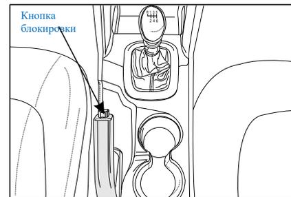
Парковка может быть выполнена с помощью ручки стояночного тормоза. При парковке просто затяните ручку стояночного тормоза силой. При отпуске стояночного тормоза слегка подтяните ручку стояночного тормоза, нажмите кнопку блокировки и полностью отпустите рычаг. В этот момент индикатор отказа тормозной системы на приборной панели автоматически отключится после того, как ручка стояночного тормоза полностью отпущена.
