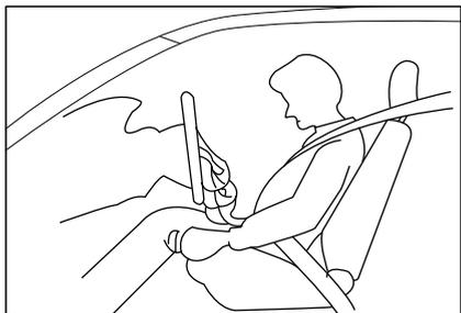
Фронтальная подушка безопасности мгновенно сдувается после срабатывания, чтобы не закрывать обзор водителя и не лишать его возможности управлять рулевым колесом или другими устройствами управления.
