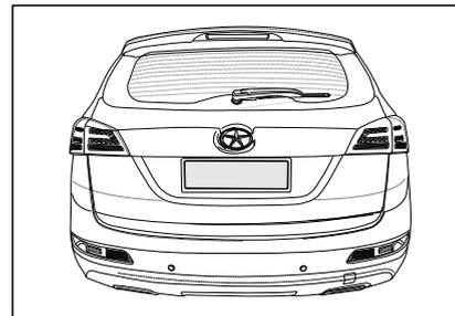
Лампа номерного знака используется, чтобы обеспечить окружающим информацию о вашем автомобиле ночью.
