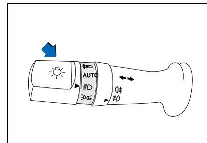
Чтобы сделать вспышку дальнего света, слегка потяните рычаг света и рычаг изменения света к себе, а затем отпустите его. Дальний свет загорится и погаснет. Даже если рычаг поворота и света меняется в положение ВЫКЛ, фары могут мигать. Слегка потяните рычаг луча света, удерживайте его. Луч будет гореть, пока вы не отпустите рычаг.
