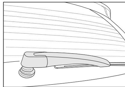
>Если вам нужно заменить задний стеклоочиститель, просто поднимите плечо стеклоочистителя, чтобы убрать его с заднего лобового стекла, затем вы можете демонтировать и сменить кусок стеклоочистителя.
