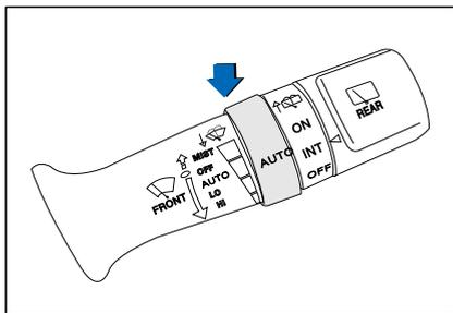
Датчик дождя расположен в верхнем конце лобового стекла для обнаружения осадков и контрольного стеклоочистителя в соответствующем временном интервале. Чем больше осадков, тем короче прерывистая операция стеклоочистителя. Если дождя нет, стеклоочиститель останавливается.
