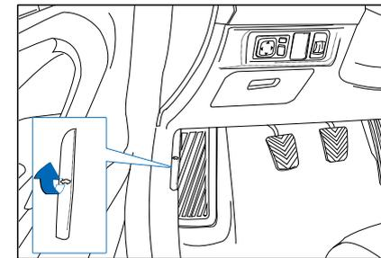
Ручка разблокировки капота двигателя расположена под левой стороной панели приборов сиденья водителя. Чтобы открыть или закрыть капот двигателя, выполните следующие действия:
