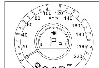
Спидометр отображает скорость движения транспортного средства. Скорость автомобиля отображается в километрах в час. В стадии обкатки, пожалуйста, обратите внимание на меры предосторожности при работе в «инструкциях по вождению». Дальнейшие инструкции см. В п. 136.
