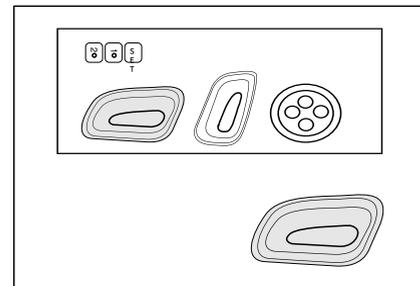
В вашем автомобиле есть регулировка высоты и положения сиденья. Шаги для регулировки высоты сиденья и его движение вперед/назад:
