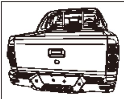
Открывая заднюю дверь, потяните за ручку открытия двери, чтобы разблокировать замок задней двери, потяните заднюю дверь назад и медленно опустите дверь в горизонтальное положение обеими руками. Ограничительный провод крышки багажника протягивает узел двери багажного отделения. При закрытии задней двери поднимите заднюю дверь из горизонтального положения и слегка надавите на нее, для открытия двери при приближении к замку.
