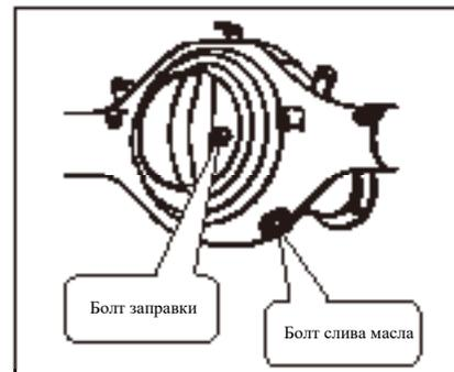
Выкрутите кран сливного отверстия в нижней части картера заднего моста и слейте трансмиссионное масло в задней оси. После того, как слив станет чистым, залейте 2,6 л специального трансмиссионного масла из контрольного отверстия уровня масла в картер заднего моста, а затем затяните кран контрольного отверстия.
