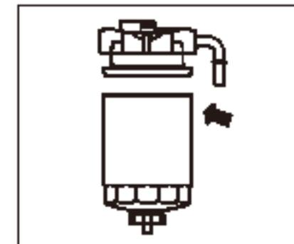
1. Ослабьте спускной винт на фильтре тонкой очистки и спускной клапан фильтра грубой очистки до тех пор, пока через спускной клапан не начнет вытекать жидкость.
