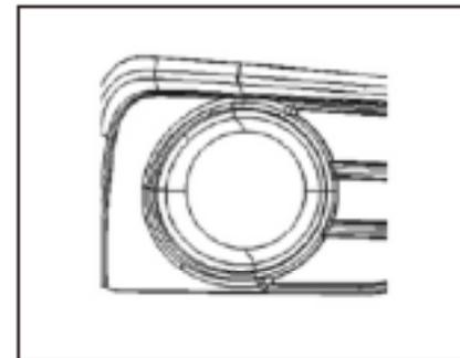
1) Передняя противотуманная фара обеспечивает определенное визуальное проникновение при плохой видимости (например, при наличии тумана), обеспечивая безопасность для вас и окружающих.
