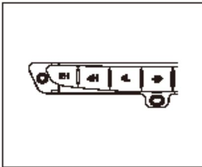
5. Двухколесный привод (2H) используется при движении по обычным дорогам и шоссе. Максимальная скорость: 140 км / ч. В процессе переключения режимов переднее колесо не должно иметь слишком больших углов, иначе плавное переключение режимов будет затруднено; при большом угле поворота, выйдите из режима полного привода, иначе это вызовет торможение, а также ускорит износ шин.
