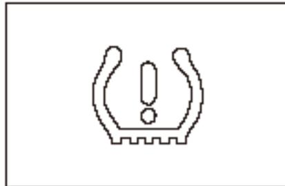
Данный индикатор загорается, когда в шинах низкое/высокое давление, стремительная утечка воздуха и чрезмерная температура.
