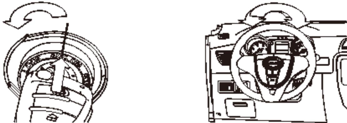
Для поворота ключа зажигания в положение LOCK нажмите его в положении ACC и поверните его в положение LOCK. Рулевое колесо будет заблокировано и можно вынуть ключ.
