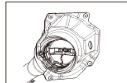
Переместите переключатель крышки топливного бака в нижней левой части основного сиденья водителя, крышка топливного бака откроется автоматически, и поверните крышку топливного бака против часовой стрелки, чтобы отвинтить ее.
