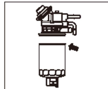
1. Ослабьте спускной винт на фильтре и спускной клапан фильтра до тех пор, пока через спускной клапан не будет вытекать жидкость.
