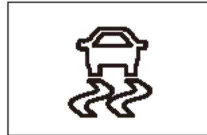
Индикатор ESC загорается при включении зажигания и гаснет примерно через 3 секунды. Когда система ESC запускается, она контролирует состояние движения, а при нормальных условиях движения индикатор ESC остается выключенным. Если во время движения индикатор ESC мигает, это означает, что дорога скользкая и мощность автомобиля достигает максимального предела сцепления. Если система ESC неисправна, индикатор горит постоянно. Обратитесь в официальный сервисный центр JAC, чтобы проверить систему.
