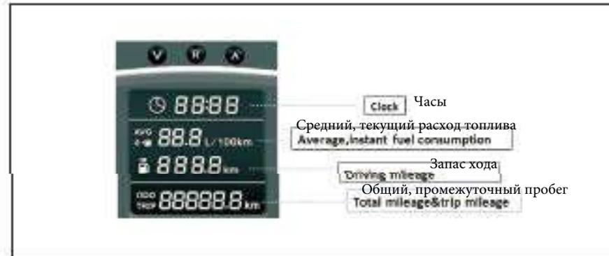
Часы: 24-часовой режим отображения с регулируемыми настройками.
