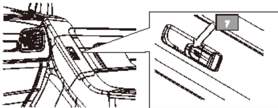
7 Передняя правая дверь, левая и правая задние двери имеют независимый вспомогательный переключатель, с помощью которого можно поднимать и опускать стекло. Когда кнопку поднимают и опускают дважды, окно автоматически поднимается и опускается до конца.
