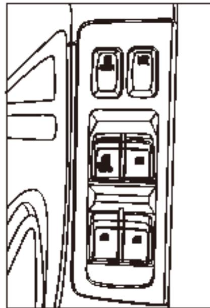
Управление стеклоподъемником со стороны водителя также включает кнопку блокировки. Нажатие на кнопку блоки-
