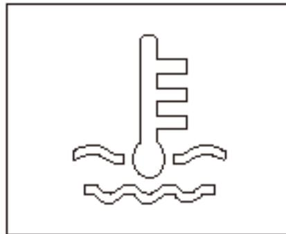
Во время движения поддерживайте температуру антифриза в пределах нормы. Если обнаружен сигнал о повышении температуры, его следует остановить и своевременно осуществить проверку. В противном случае увеличится расход топлива, и двигатель будет работать размеренно.
