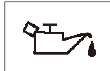
При недостаточном давлении масла или неисправности системы загорается индикатор давления масла. В нормальных условиях индикатор давления моторного масла загорается при включении зажигания и гаснет после запуска двигателя. Если индикатор не гаснет после запуска двигателя или загорается во время движения, это указывает на недостаточный уровень моторного масла или возможную неисправность системы смазки двигателя.
