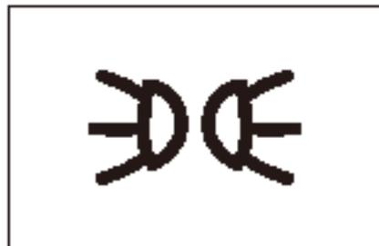
Когда замок зажигания включен в положение «ON», на панели комбинированных переключателей включится индикатор габаритного фонаря, в это же время подсветка приборной панели уменьшится до 80%.
