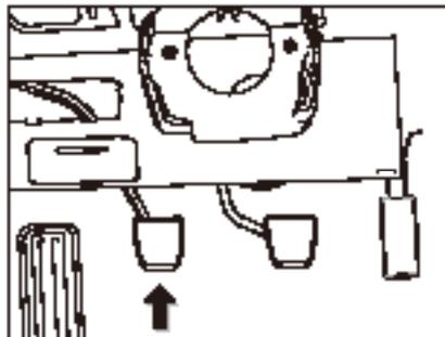
Чтобы выключить сцепление, педаль сцепления должна быть выжата до упора, иначе шестерня трансмиссии будет издавать звук трения, а фрикционный диск сцепления быстро изнашивается, и коробка передач может быть зазубренной при переключении передачи, что может привести к повреждению передачи. Не ставьте ногу на педаль сцепления, если вы ее не используете.
