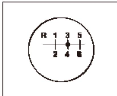
2. Принципиальная схема положения шестерни на рукоятке; при парковке установите рычаг переключения передач в нейтральное положение.
