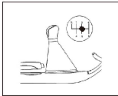
1. Установите рычаг переключения передач в нейтральное положение.
