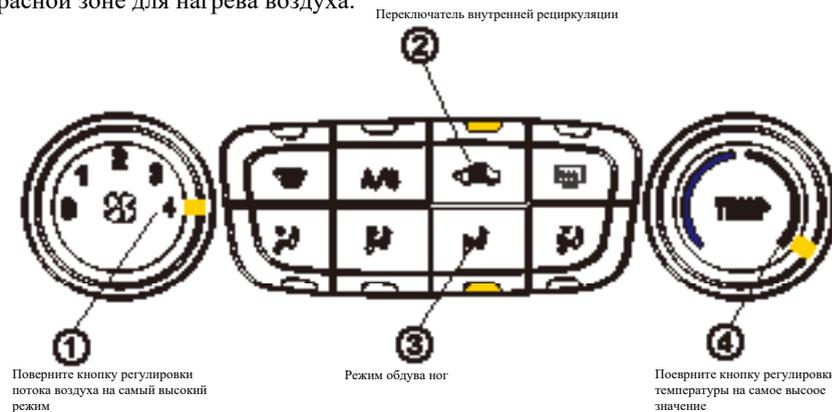
1 Поверните кнопку регулировки потока воздуха на самый высокий режим
