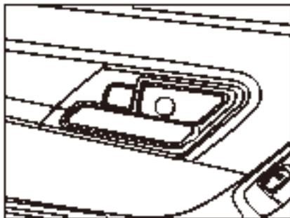
Чтобы запереть дверь изнутри автомобиля, нажмите кнопку блокировки дверцы внутрь.
