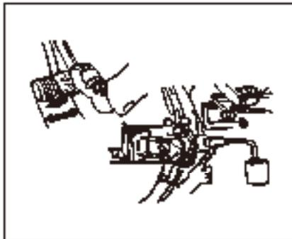
6. Медленно отпустите педаль сцепления и повторяйте работу до тех пор, пока пузырь в жидкости сцепления, закачанной в емкость, не исчезнет. Во время процесса выпуска жидкость для сцепления в баке для хранения жидкости для сцепления должна поддерживаться на заданном уровне. После выхлопа необходимо переустановить резиновую крышку.
