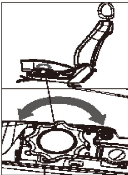
В вашем автомобиле есть ручка ручной регулировки высоты сиденья, которая расположена на внешней стороне сиденья. 1. Поверните ручку, чтобы отрегулировать сиденье до желаемой высоты. Поворачивайте ручку против и по часовой стрелке.
