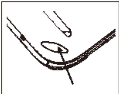
Сигнальный фонарь открытой двери расположен на внутренней стороне двери, ниже внешнего края. Когда вы открываете левую и правую переднюю дверь, загораются соответствующие лампы внутренней двери, а после того, как вы закрываете любую из передних дверей, соответствующие дверные фонари гаснут.
