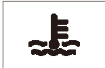
Свечение данного индикатора означает, что температура охлаждающей жидкости превышает норму. В таком случае немедленно остановите автомобиль, выключите двигатель, откройте крышку капота и проверьте уровень температуры охлаждающей жидкости, а также ремень привода насоса системы охлаждения. При наличии признаков неисправности системы охлаждения обратитесь в официальный сервисный центр JAC для диагностики системы.
