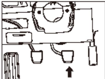
Чтобы избежать резкого торможения, педаль тормоза должна нажиматься плавно. Если двигатель остановлен, усилитель тормозов не сможет полностью выполнить свою роль, поэтому эффект торможения будет снижен. В этом случае педаль тормоза следует нажимать с интенсивной силой, чтобы добиться тормозного эффекта.
