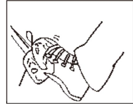
9. Проверьте зазор и высоту педали тормоза, рабочую исправность
