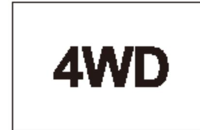
Индикатор горит, когда автомобиль находится в высокоскоростном режиме системы полного привода.
