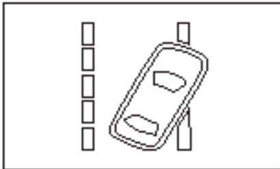
Система слежения за дорожной разметкой предназначена для предупреждения невнимательного или утомленного водителя с помощью интеллектуального слежения за дорожной разметкой.
