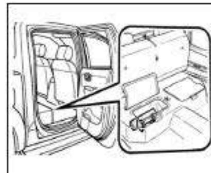
Домкрат размещается под подушкой заднего левого сиденья. Бортовой инструмент помещается в карман за спинкой заднего сиденья для снятия гаечного ключа колесной гайки, а также двух подъемных устройств и заводной рукоятки.
