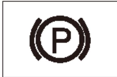
При включении замка зажигания в положение «ON» нажатой ручной тормоз, загорается индикатор. При отпуске ручного тормоза индикатор погаснет.
