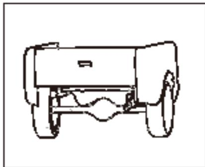
Проверьте, не издает ли двигатель аномальный шум, а также цвет выхлопа.
