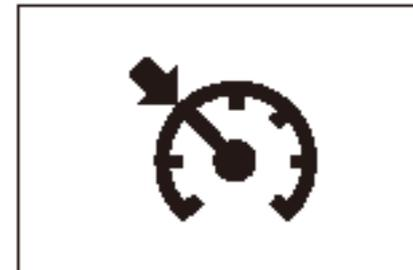
Если дорожные условия позволяют, можно включить круиз-контроль, нажав кнопку «SET», загорится индикатор, и автомобиль перейдет в состояние круиза. Нажмите кнопку круиз-контроля, чтобы отменить его, или нажмите педаль тормоза, индикатор погаснет, автомобиль выйдет из состояния круиза.
