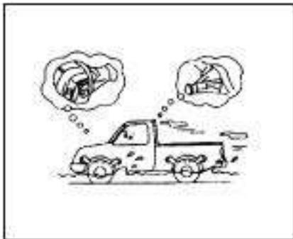
10) Не допускайте попадания воды в трубу двигателя при движении по мелководью или лужам, что может привести к серьезным повреждениям двигателя. После движения в таких условиях убедитесь, что трансмиссионное масло переднего и заднего мостов и коробки передач не смешано с водой. При обнаружении излишней жидкости ее следует слить после заливки трансмиссионного масла.
