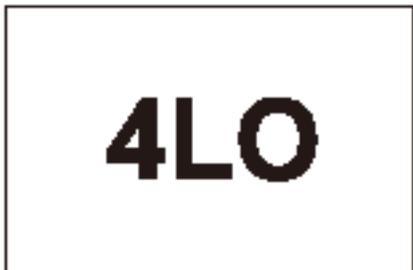
Индикатор горит, когда автомобиль находится в низкоскоростном режиме системы полного привода.
