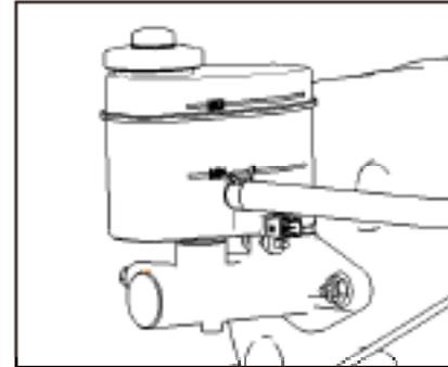
7. Проверьте достигает ли уровень тормозной жидкости в бачке указанной отметки.
