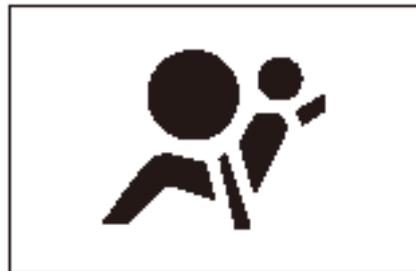
Индикатор системы подушек безопасности (SRS) загорается при включении зажигания в положение «ON» или запуске двигателя, и гаснет через 6 секунд. Это указывает на функциональную готовность системы. Если индикатор не выключается или остается включенным во время вождения или мигает и выключается, это означает, что система подушек безопасности неисправна, в этом случае необходимо обратиться в официальный сервисный центр JAC для диагностики системы подушек безопасности.
