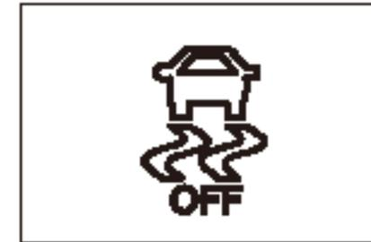
Нажмите кнопку переключателя ESC OFF, после этого загорится индикатор ESC OFF, указывая на то, что система ESC не работает.
