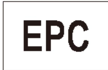
Если индикатор загорается во время движения автомобиля или не загорается при включении зажигания, это указывает на нестабильную работу или неисправность системы контроля отработавших газов. В таком случае как можно скорее обратитесь в официальный сервисный центр JAC для диагностики системы. Продолжительное движение при таких обстоятельствах может стать причиной дальнейшего повреждения компонентов системы контроля отработавших газов, а также существенно снизить эффективность ее работы.
