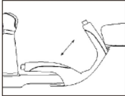
Убедитесь, что ход рычага стояночного тормоза находится в исправном состоянии, и что автомобиль можно безопасно парковать на крутом склоне, при использовании только стояночного тормоза.
