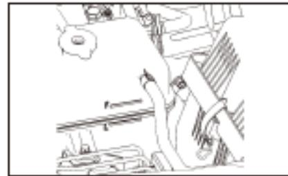
Если уровень воды в расширительном бачке ниже «L» (нижний предел), проверьте количество антифриза и, при необходимости, залейте его в расширительный бак. По шкале следует проверить, не протекает ли радиатор или другие части системы охлаждения, а затем залейте незамерзающую жидкость до отметки «F» (верхний предел) шкалы.
