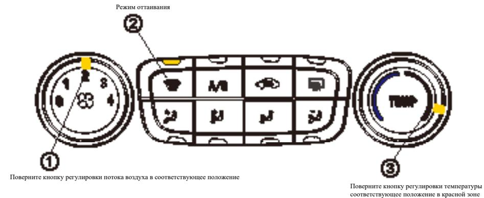
1 Поверните кнопку регулировки потока воздуха в соответствующее положение
