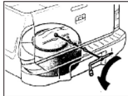
В центре под задней панелью находится овальное отверстие. Вставьте коромысло шины в отверстие, чтобы выровнять лебедку для запасного колеса. Выдвиньте коромысло шины и вставьте его в Т-образное отверстие лебедки для запасного колеса, затем поверните коромысло колеса против часовой стрелки, чтобы опустить запасное колесо. Когда запасное колесо полностью опущено, извлеките запасной диск из нижней части автомобиля и осторожно снимите запасное колесо из нижней задней части автомобиля.
