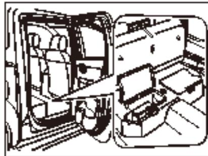
Домкрат находится под подушкой заднего левого сиденья. Инструмент размещается под левым задним сиденьем. Ключ для гайки колеса и два узла подъемной тяги и рукоятки кривошипа синтезируют ключ для гайки колеса и два узла подъемной штанги и рукоятку кривошипа синтез. Запасное колесо должно быть демонтировано, как показано на рисунке.
