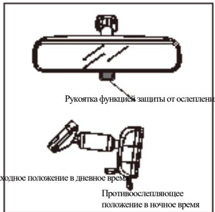
Перед началом движения необходимо отрегулировать внутренние и наружные зеркала заднего вида на оптимальный угол обзора, сохраняя зеркало заднего вида в чистоте. При регулировке зеркала заднего вида удерживайте зеркало за середину вверх или вниз или влево и вправо, пока не увидите автомобиль позади. Если вам необходимо антибликовое покрытие при вождении в ночное время, выберите данный режим
