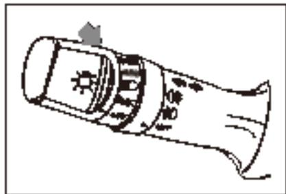
Вынув ключ из замка зажигания в положении LOCK, поднимите рычаг переключения светового сигнала поворота (рычаг переключения света фар) в направлении рулевого колеса и затем отпустите его. Включится функция «Accompany Me Home» ("Проводи меня домой"), после чего фары будут гореть постоянно в течение 30 секунд.
