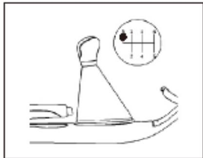
Каждый раз перед переключением педаль сцепления нужно нажимать вниз. Схема положения переключателя находится в верхней части рукоятки рычага переключения передач. Когда рычаг переключения передач находится в положении заднего хода, а ключ пускового переключателя находится в положении «включено», загорается индикаторная лампа заднего хода.
