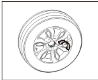
1. Ослабьте колесную гайку против часовой стрелки с помощью ключа для колесных гаек и не снимайте ее.
