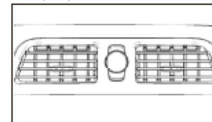
Центральное отверстие для обдува лица всегда открыто. Может регулировать направление потока с помощью выступа, его можно закрыть с помощью настройки кондиционера
