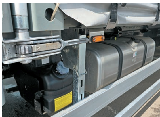
16-литровый бачок с AdBlue и топливный бак увеличенной до 210 л ёмкости выполнены из алюминия, равно как и воздушные ресиверы пневматической тормозной системы
