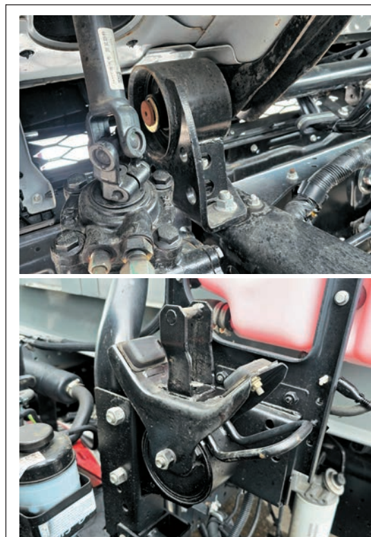
Подвеска кабины: спереди торсионы, сзади опоры с замками
