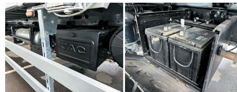
◆ Ящик с АКБ (2x120 Ач) полностью закрыт от внешних воздействий
