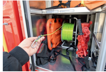
Светящийся трос нужен для работы звена в задымленном помещении
