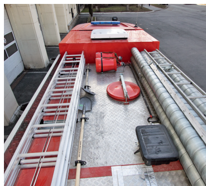
Вид на крышу: слева лестница, справа пеналы для рукавов, спереди видны люк для заправки водой и пеногенераторы
