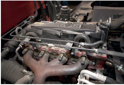
Под кабиной — Cummins 4.5 мощностью 207 л.с.
