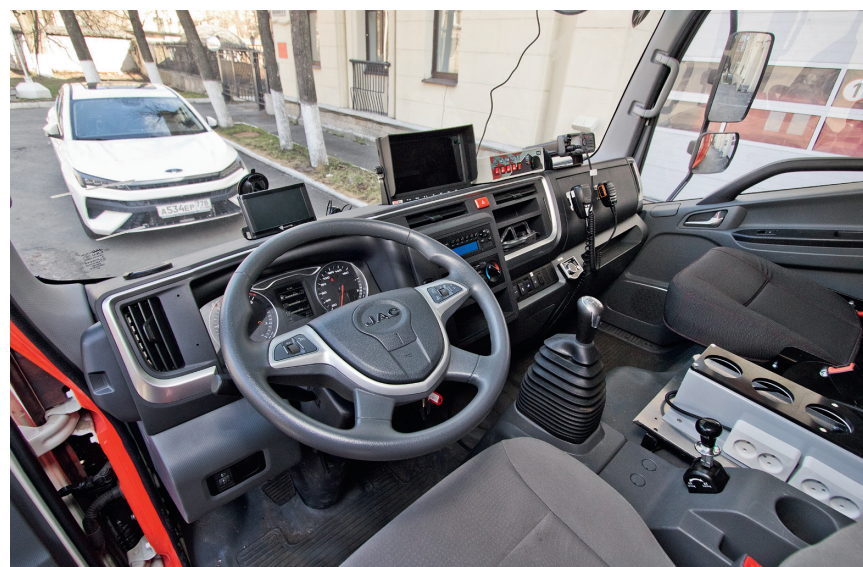
Интерьер кабины аккуратный и современный, а передняя панель позволила разместить на ней все, что нужно. Справа от водителя — розетки на 220 В
