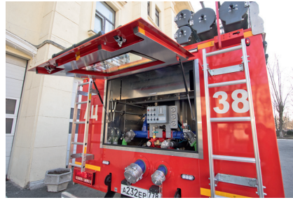
Сзади — турецкий двухступенчатый насос Celiksas
