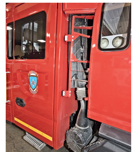
Верхнюю часть воздухозаборника пожарные приспособили сами, от Isuzu
