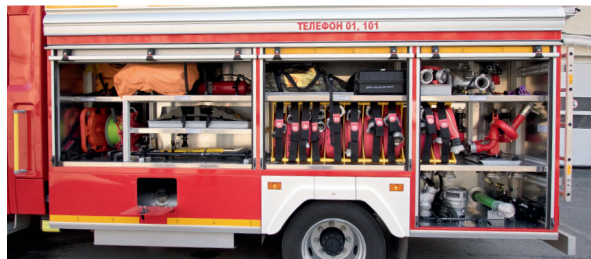
В отсеках с алюминиевыми шторными дверями размещено самое разное ПТВ, пожарно-техническое вооружение. Внутри надстройки — цистерна на 2 т воды и бак для пенообразователя на 180 л из полиэтилена низкого давления (ПНД)
