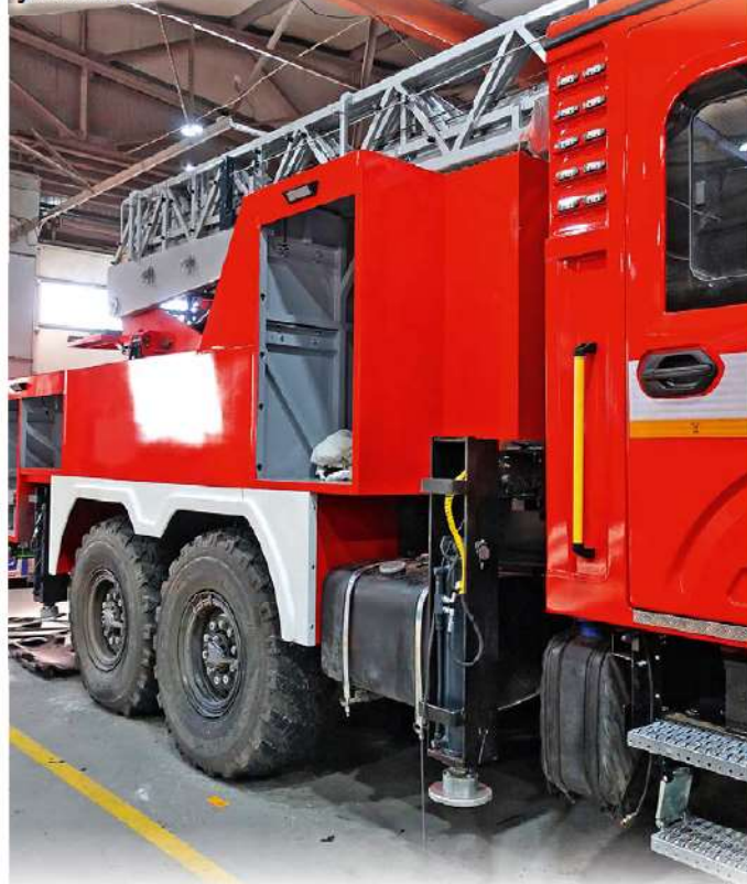
Автомобили с пожарными лестницами оснащаются аутригерами для повышения устойчивости
