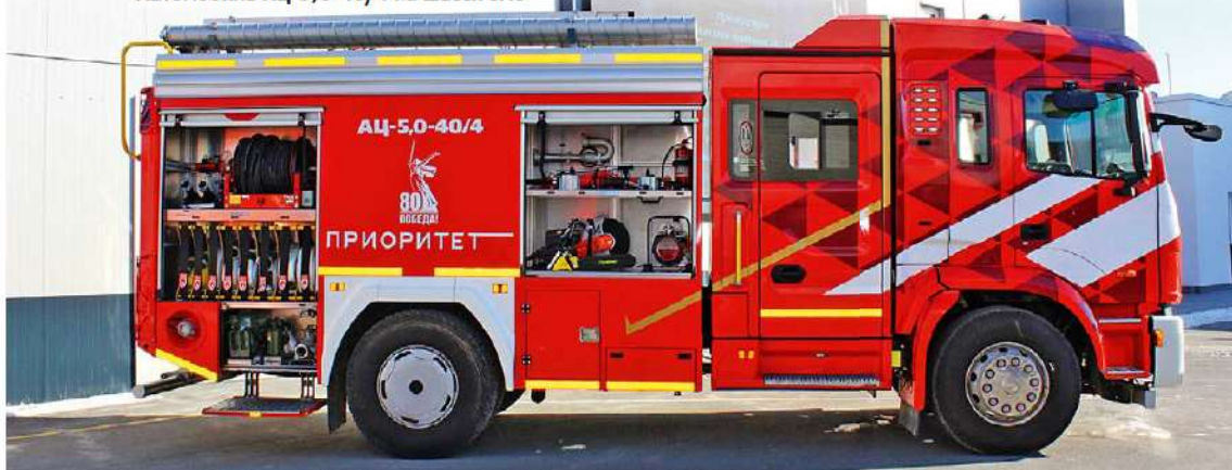
Пожарное оборудование удобно располагается в кузове с каркасом из алюминиевого профиля на болтовых соединениях. Автомобиль АЦ-5,0-40/4 на шасси JAC
