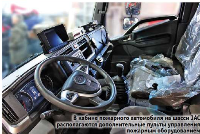
Пульты для управления пожарным оборудованием автомобилей (пожарным насосом, лафетным стволом и т.д.) собирают на заводе «Приоритет»
