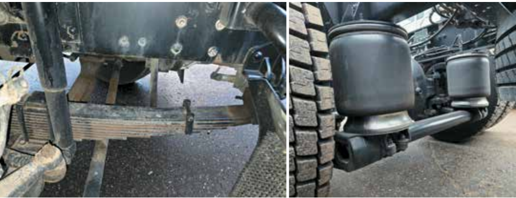
Шасси N200: передняя подвеска – многорычковые рессоры, задняя – внизу два пневмобаллона и продольные рычаги, сверху ведущий мост держит V-образная тяга
