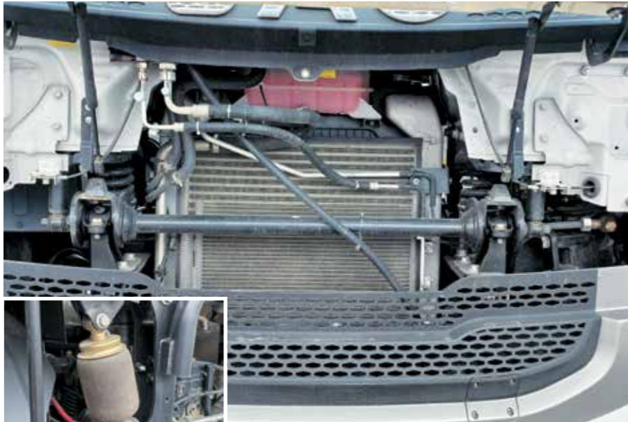
Подвеска кабины четырехточечная: сзади пневмобаллоны, спереди пружины плюс стабилизатор
