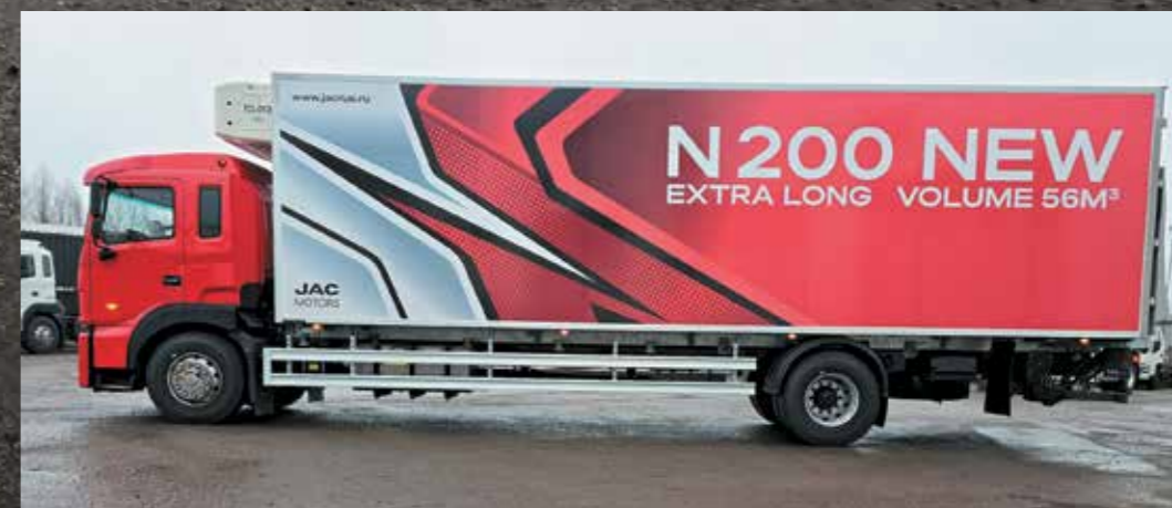
JAC N200 в версии Extra Long с колесной базой 7150 мм, что позволило разместить на шасси фургон вместимостью 56 м 3
