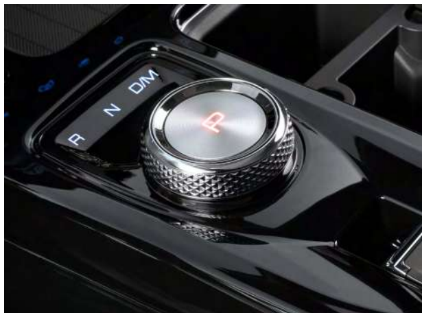
Электронный джойстик коробки передач
