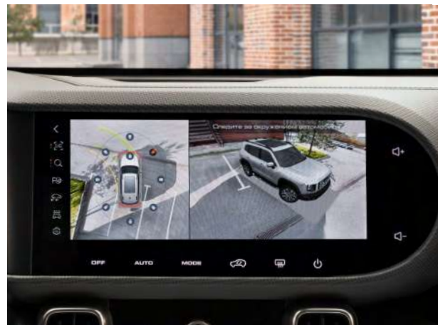
Система камер кругового обзора 360°
