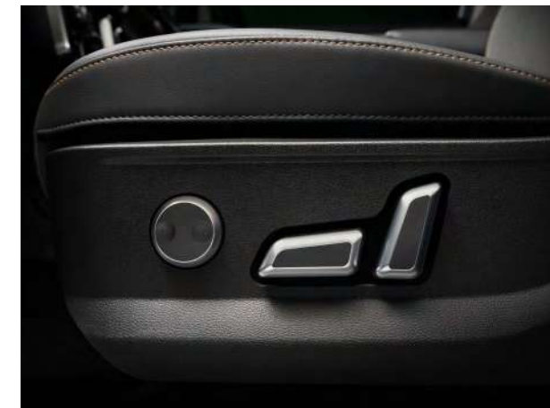
Электрорегулировка сиденья водителя в 8 направлениях
