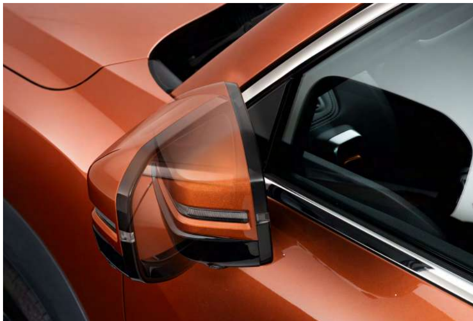
Зеркала с электроприводом складывания
