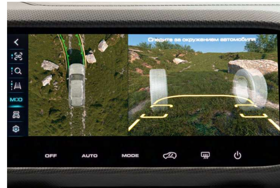
Функция также показывает угол поворота передних колес
