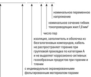
кабель монтажный ИнСил-ИЭз для промышленных сетей опасных производственных объектов
