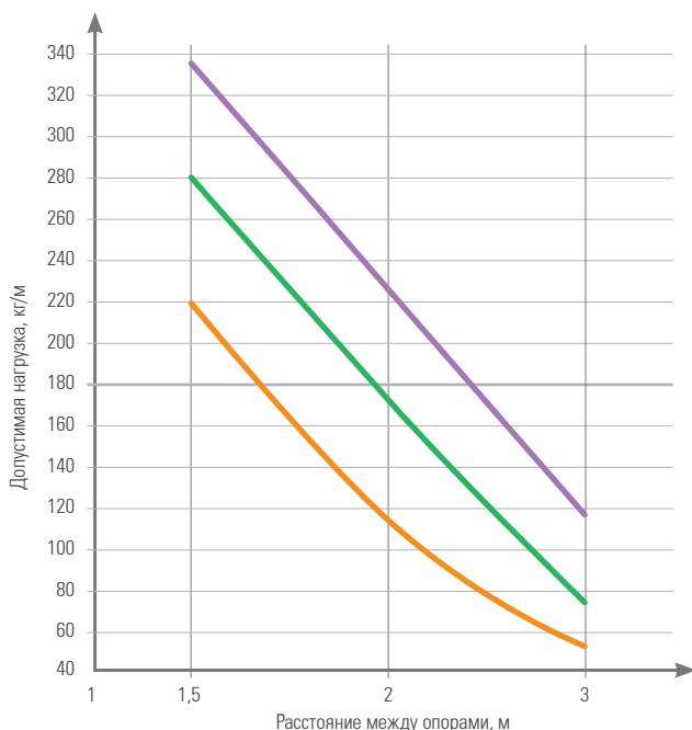
БРН составляет 80% от данных, полученных при испытании на нагрузку по ГОСТ 52868-2007 с соблюдением следующих условий:
