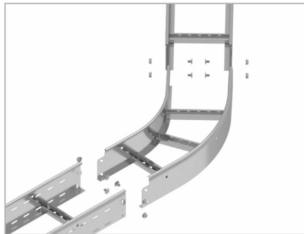
Соединение лотков серии ЛТ-02 и поворота горизонтального 45°
