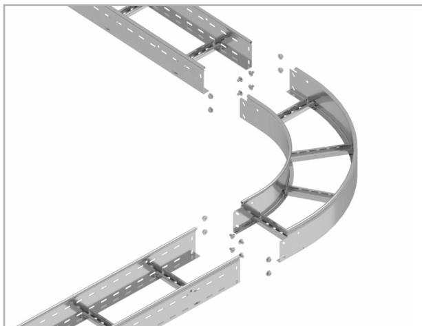
Соединение лотков серии ЛТ-02 и поворота горизонтального 90°
