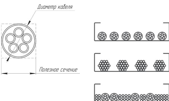
В таблице №3 приведены геометрические размеры некоторых кабелей. За более точными и полными данными обратитесь к производителю кабельной продукции.
