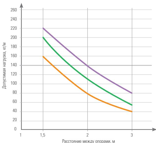
БРН составляет 80% от данных, полученных при испытании на нагрузку по ГОСТ 52868-2007 с соблюдением следующих условий:
