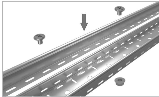
Монтаж разделительной перегородки в прямой лоток
