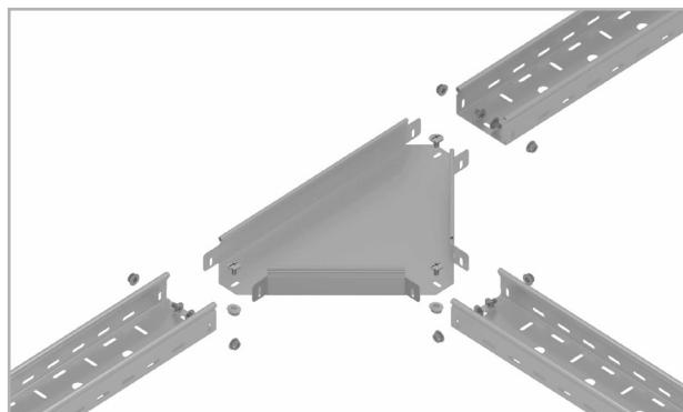
Соединение лотков серии СТ-02 и ответвителя Т-образного
