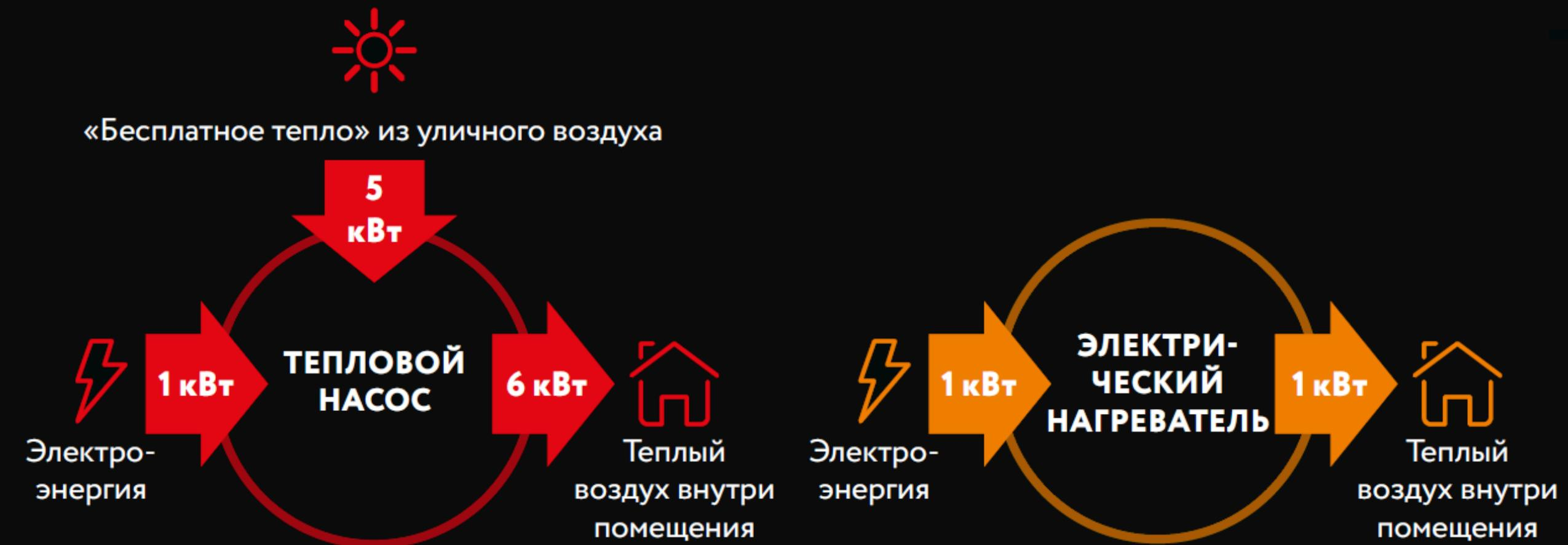
**ПРИНЦИП РАБОТЫ ТЕПЛОВОГО НАСОСА – НЕ СОЗДАНИЕ ТЕПЛА,
