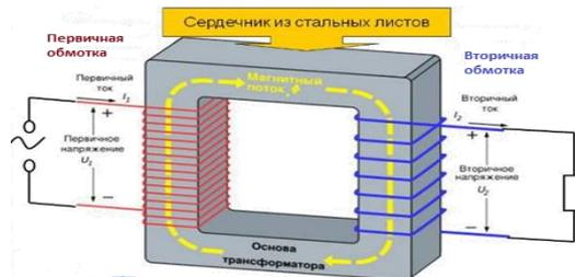
Первичная и вторичная обмотка трансформатора тока связаны через железный магнитопровод. Ток во вторичной цепи пропорционален первичному. Сопротивление нагрузки оказывает сильное влияние на точность. Наличие железного магнитопровода приводит к насыщению трансформатора.
