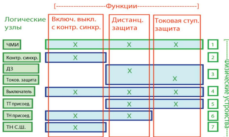
**Рис. 3. Взаимосвязь между функциями, логическими узлами и физическими узлами (пример)**
