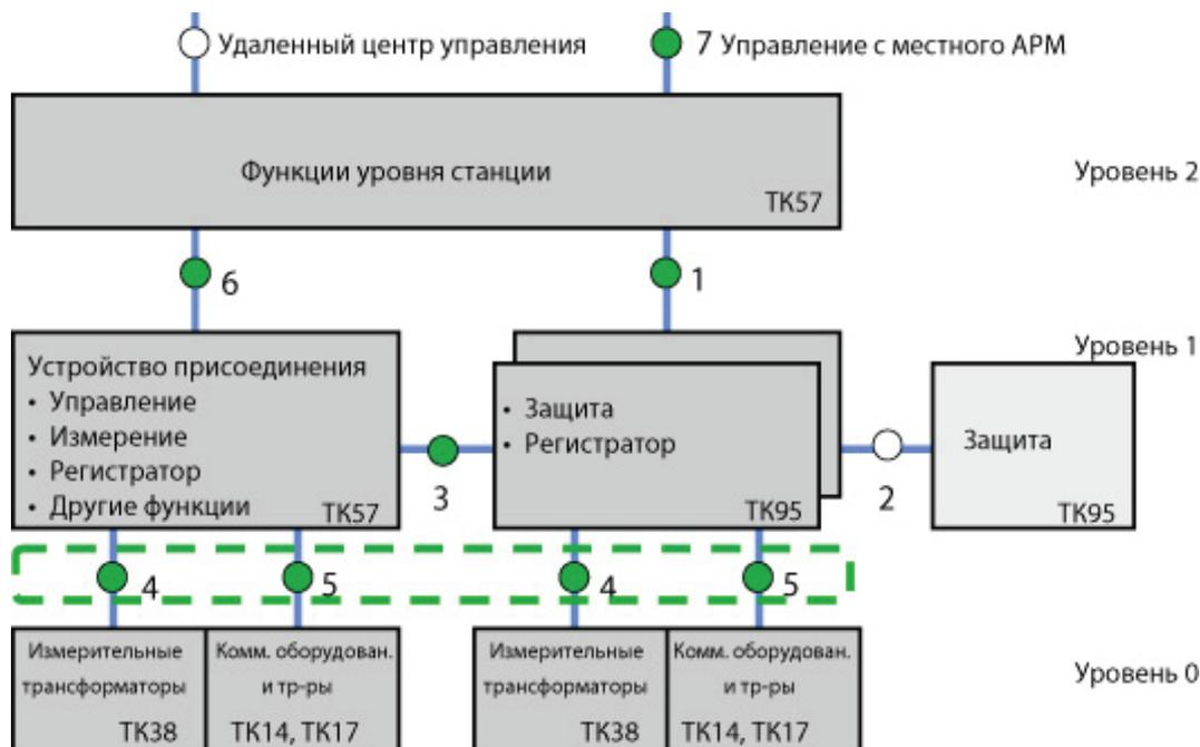
**Рис. 1. Логические интерфейсы системы автоматизации подстанции**
