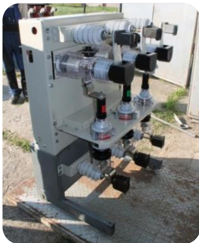
Smart-ретрофит ячеек ЗРУ центров питания
