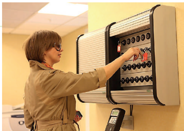
▲ Использование электронных ключниц для контроля посещаемости сотрудников и выключения кондиционеров в пустых комнатах ЗАО «КРОК инкорпорейтед»
