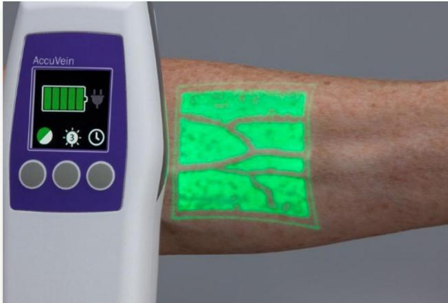
В компании AccuVein разработали сканер, который просвечивает кожу и на основе полученных данных проецирует на ее поверхность вены, их разветвления и мельчайшие кровеносные сосуды. Технология призвана упростить забор крови, сведя ошибки врачей и медсестер к минимуму.
