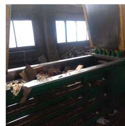
Гидравлический пресс и формируе- мый в нем тьюк картона
