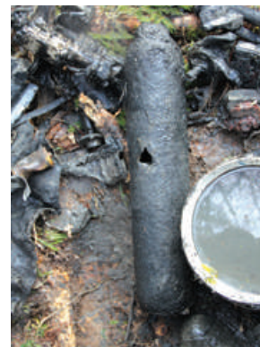
Баллон сжатого воздуха, пробитый снарядом калибра 20 мм
