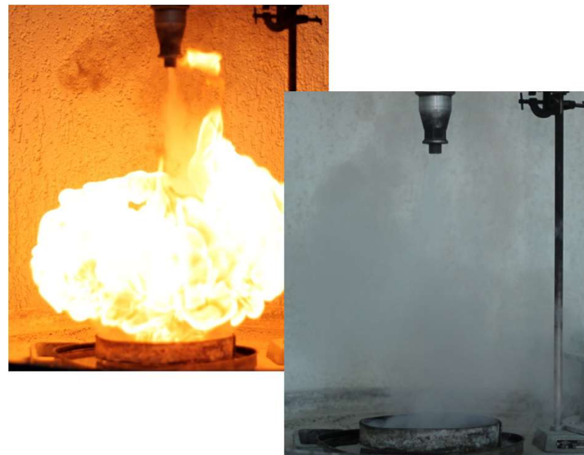
Тушение модельных очагов пожара: бензин
