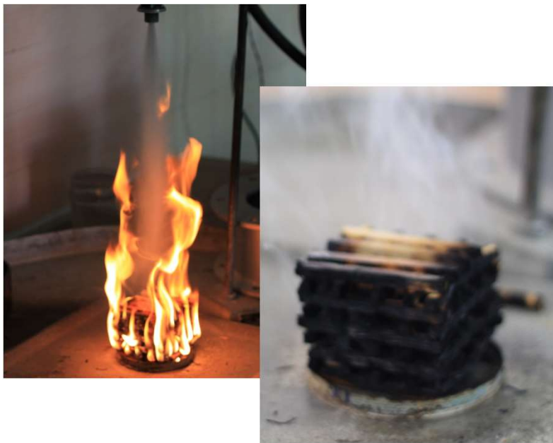
Тушение модельных очагов пожара: древесины
