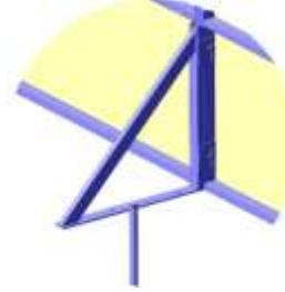
2. свободностоящих вмораживаемых треугольных опор из профильной трубы 50x25x1,5мм, высота опор составляет 600мм.
