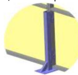
4. с помощью вертикальных бетонируемых опор, выполненных из профильной трубы 50x50x3мм. Глубина бетонирования 600 мм.
