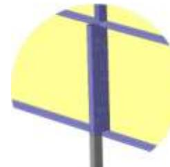
5. с помощью треугольных опор, выполненных из профильной трубы 50x25x1,5мм, которые крепятся к основанию с помощью двух анкерных болтов
