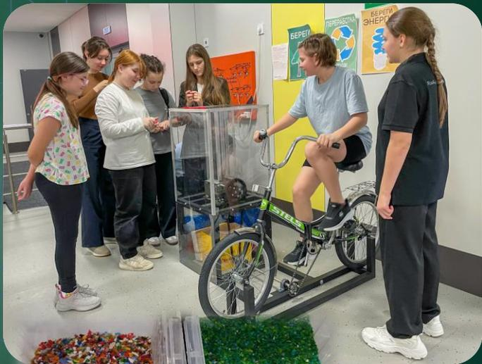
Эко-тренажер производит нагрев и впрыск пластика под давлением жима рычага в пресс-формы для изготовления изделий, укрепляет мышцы плечевого пояса
