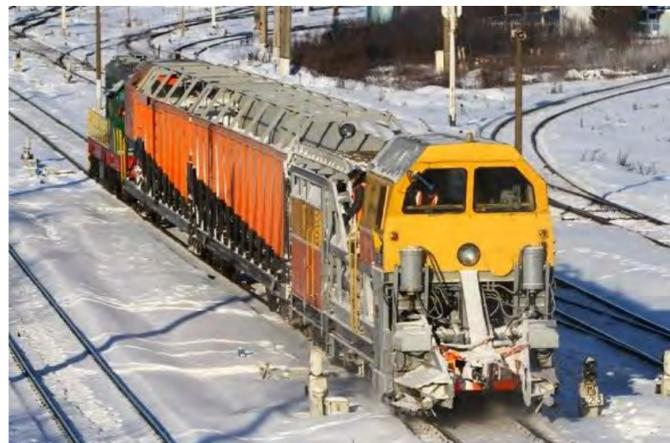
Работает без скалывателя льда, автоматически загружая снег в кузов и выгружая его в отведенных местах или в вагоны на соседнем пути
