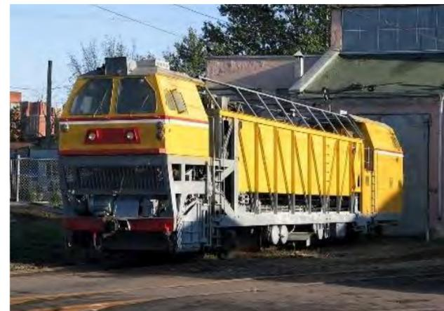
Работает без скалывателя льда. Обеспечивает механизированную загрузку и выгрузку снега в кузов, в вагоны на соседнем пути или на сторону через выбросной ротор на расстояние до 30 м
