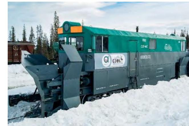
Представляет собой специальный вагон, оборудованный по концам отвальными плоскостями. В сцепе с локомотивом, который ставится впереди или позади, обеспечивает очистку от снега на повышенной скорости
