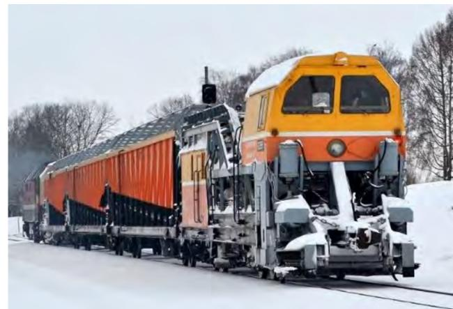
В состав поезда входят головная машина, два промежуточных и один концевой полувагон
