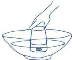
Налейте полмиски воды. Бросьте в воду пробку и накройте плавающую пробку стаканом; погрузите стакан глубоко в воду.
