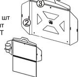
В кронштейне - 2 отверстия для навешивания на стену. Для разметки отверстий на стене использовать шаблон из комплекта.
