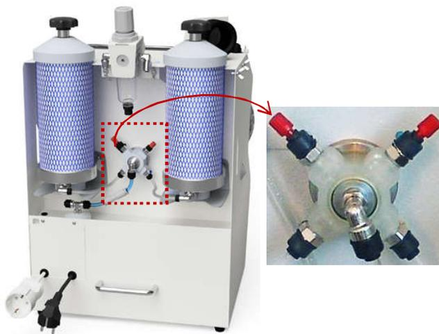
**Пример с АСОЗ АРТ КАСТ:** подключите **долото** к штуцеру пневмораспределителя.
