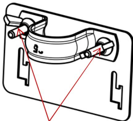
гайки-барашек для фиксации скобы на стойку-трубу
