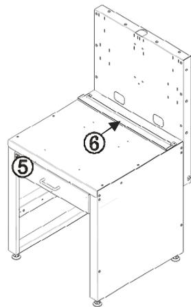
**!** «Окна» в задней стенке используются для проводки кабелей или шлангов к рабочей зоне стола, применить подвязочную проволоку.
