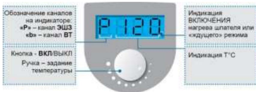
Включение **ВТ** – удержанием в нажатом состоянии кнопки ВКЛ/ВЫКЛ (около 2 сек). Установится «*рабочий*» режим – управление каналом **ВТ** или **ЭШЗ**.
