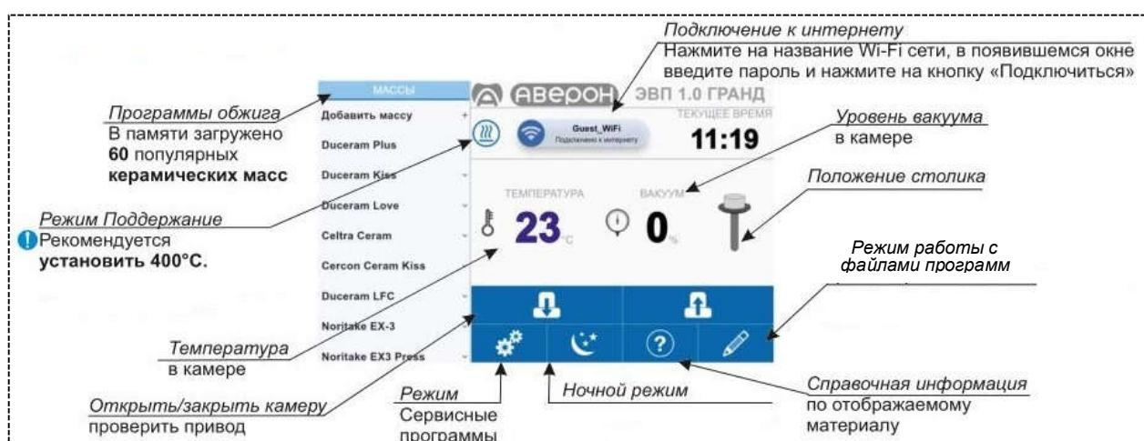
Включите ЭВП сетевым выключателем 0/1 (6): около минуты на дисплее отображается логотип АВЕРОН, после чего отображается исходное состояние - текущие параметры, дата, время, подключение к Wi-Fi сети и кнопки.
