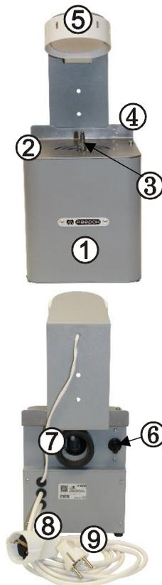
• очистите внутренний отсек, одновременно зафиксируйте ключом S=13 шпindel, другим ключом S=17 ослабьте гайку и замените фрезу. Установите фрезу режущим краем ниже уровня платформы на 1 мм. Закрутите зажимную гайку. Установите и закрепите платформу (2) винтами.
