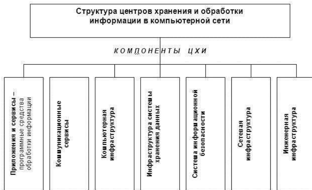
Рис. 1. Комплексная система управления и консолидированной обработки информации
