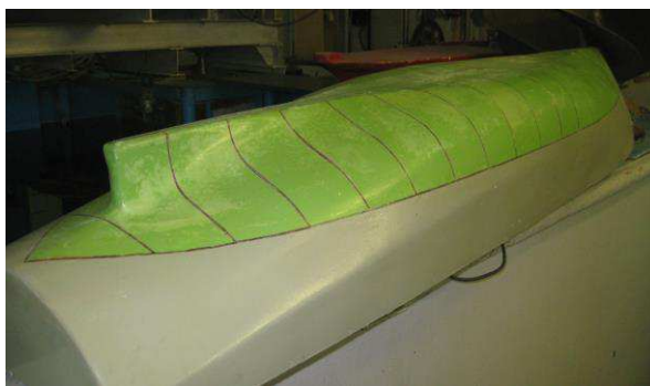
Рис. 1. Лабораторная модель корпуса судна
