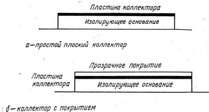
Рис. 1. Плоские солнечные коллекторы
