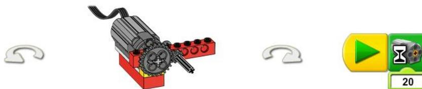
Рис. 5. Модель и программа для изучения повышающей зубчатой передачи
