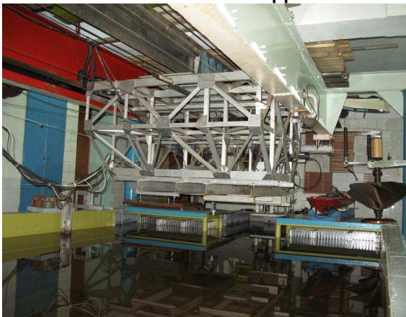
Рис. 2 Чаша опытового бассейна, буксировочная тележка с ЛАД и волногаситель
