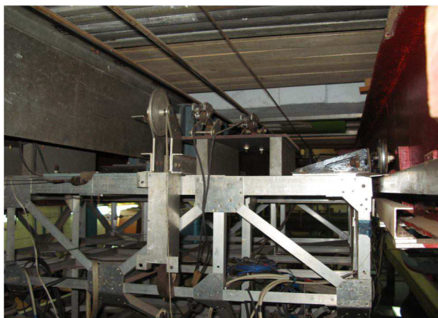
Рис. 5. Линейный асинхронный электродвигатель (ЛАД) на буксировочной тележке
