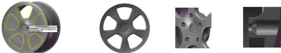
Рис. 15. Этапы моделирования диска колеса
