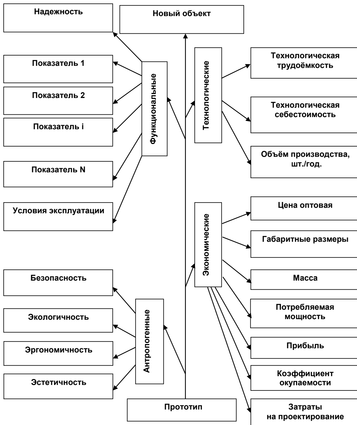
Примерный вид дерева целей для технического объекта
