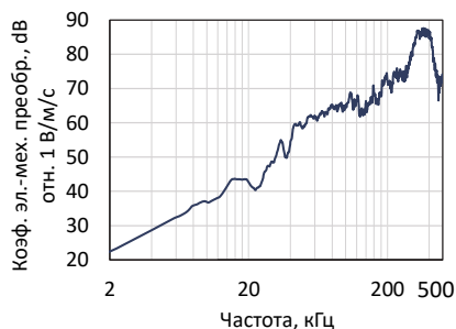
Рис. 2. Коэффициент электромеханического преобразования ПАЭ GT301, полученный совместно с усилителем
