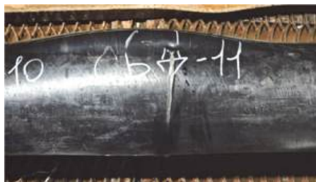
Рис. 8. Образец СБ-Д11 при повторном АЭ-контроле: а – общий вид образца перед испытанием, б – вид разрушенного образца
