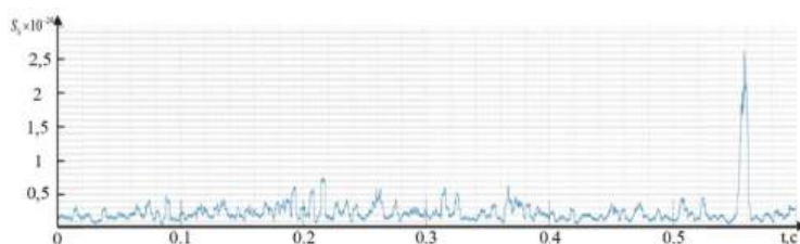
Рис. 2. График зависимости центрального момента шестого порядка амплитуды импульсов АЭ от времени
