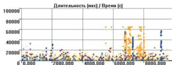
Рис. 9. Зависимость параметров импульсов АЭ от времени на одной из расстановок, расположенных на трубопроводе гидроочищенной нефти: a – зависимость суммарного счета импульсов АЭ от времени, б – зависимость амплитуды импульсов АЭ от времени, в – зависимость активности импульса АЭ от времени, г – зависимости длительности импульса
