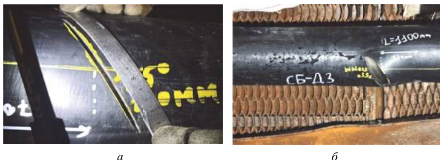
Рис. 2. Образец СБ-Д3 при повторном АЭ-контроле:
