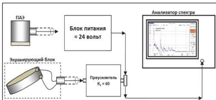
Рис. 2. Схема № 2 измерения шумовых характеристик ПАЭ
