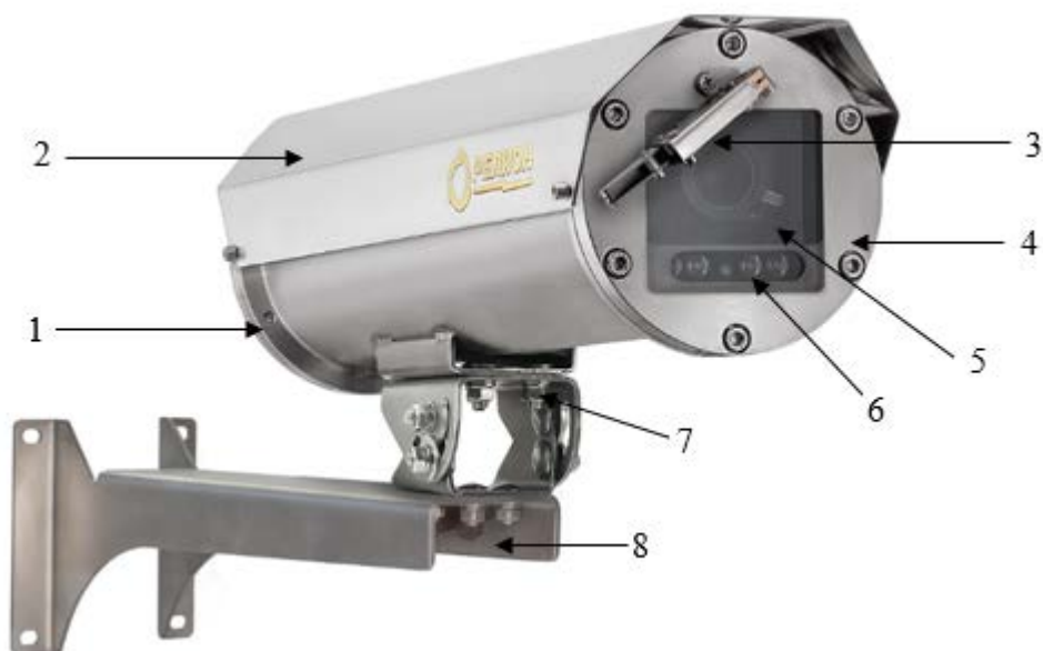
1 – основание с выходами под кабельные вводы; 2 – солнцезащитный козырек; 3 – стеклоочиститель; 4 – лицевая панель; 5 – смотровое окно; 6 – ИК-подсветка; 7 – болт крепления крепежно-юстировочного устройства; 8 – крепежно-юстировочное устройство. Рисунок 7. Внешний вид Релион-Н-300-ИК-СО
