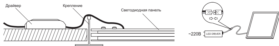
Схема крепления ультратонкой светодиодной панели.
